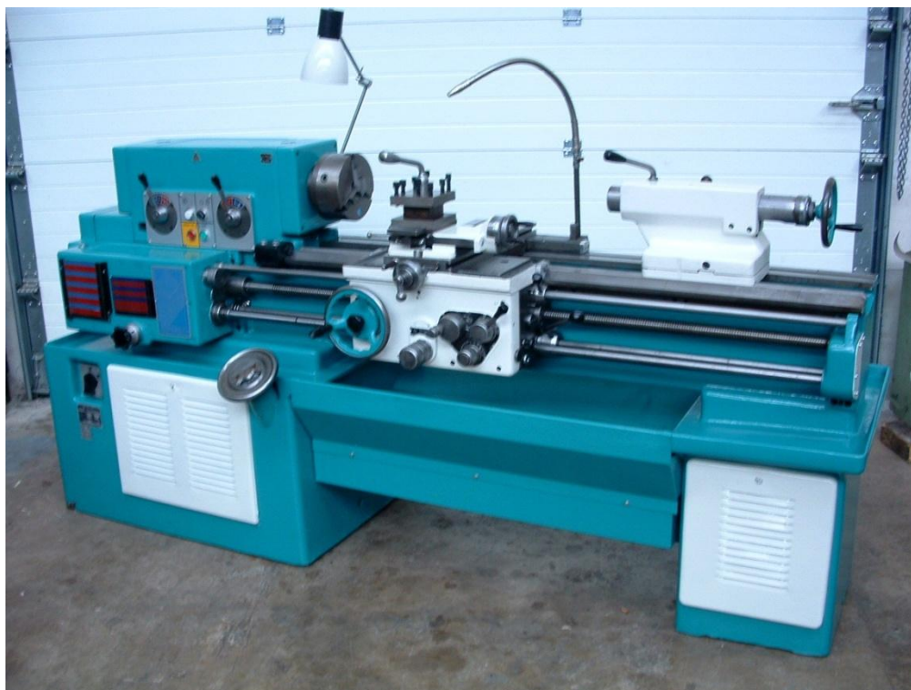
Obr.2.1.2 Univerzální hrotový soustruh SV18.
