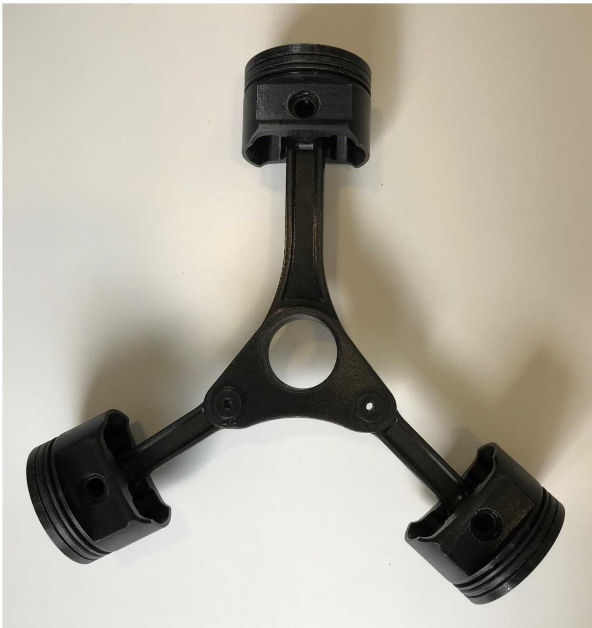
Obrázek 21 – Vytištěná sestava hlavní a vedlejších ojníc s pístními skupinami
