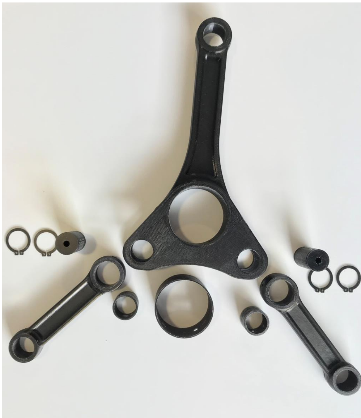
Obrázek 13 – Vytisktřená sestava hlavní a vedlejších ojnic před montáží
