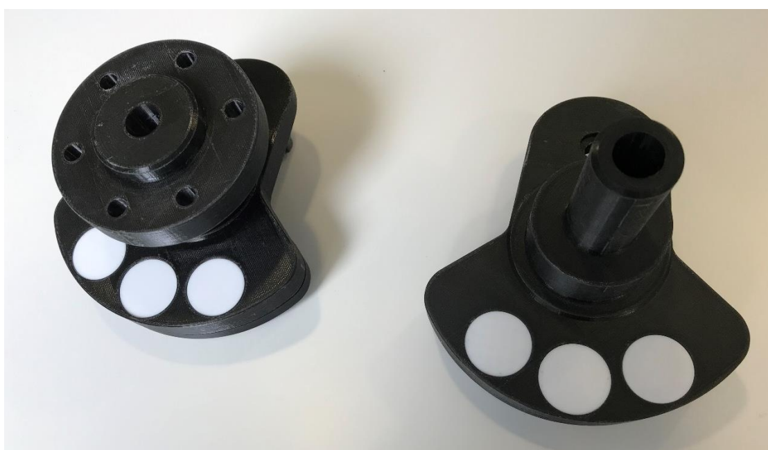
Obrázek 17 – Zalomení klikové hřídele se zalisovanými jádry
