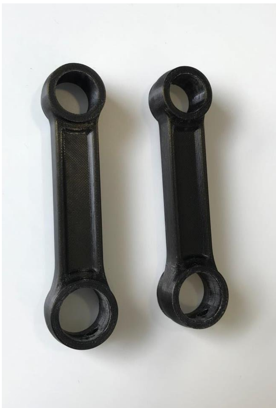
Obrázek 8 - Vytiskněné modely vedlejších ojníc
