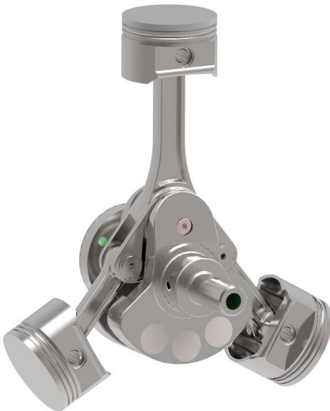
Obrázek 20 – Render sestavy klikového mechanismu tříválcového zážehového hvězdicového motoru
