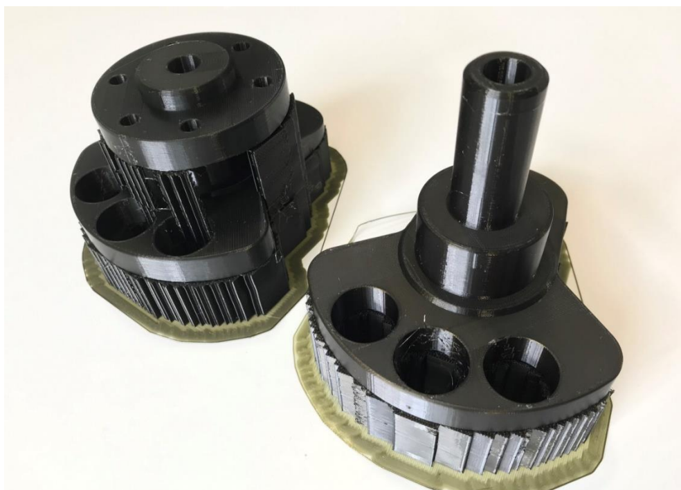
Obrázek 16 – Vytiskněné zalomení klikové hřídele s podporami
