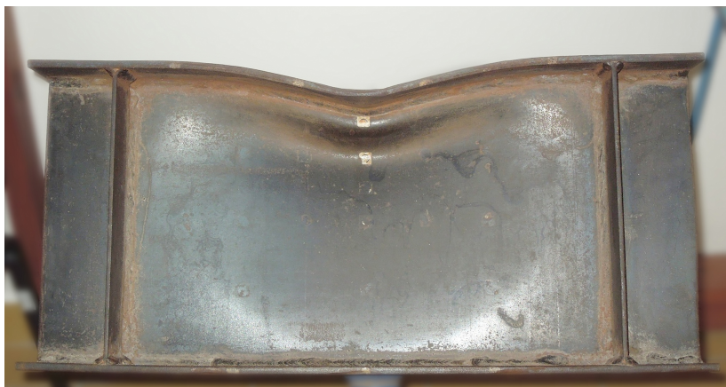
Obr. 1.4: Deformovaný I profil, vystavený na Ústavu kovových a dřevěných konstrukcí Fakulty stavební na VUT v Brně
