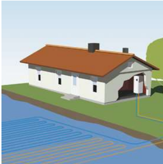
Obrázek 10: Tepelné čerpadlo voda – voda: vodní plocha [19]
