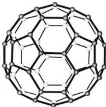
Obr. 4 Základná nesubstituovaná štruktúra molekuly fullerenu C_{60} [21].
