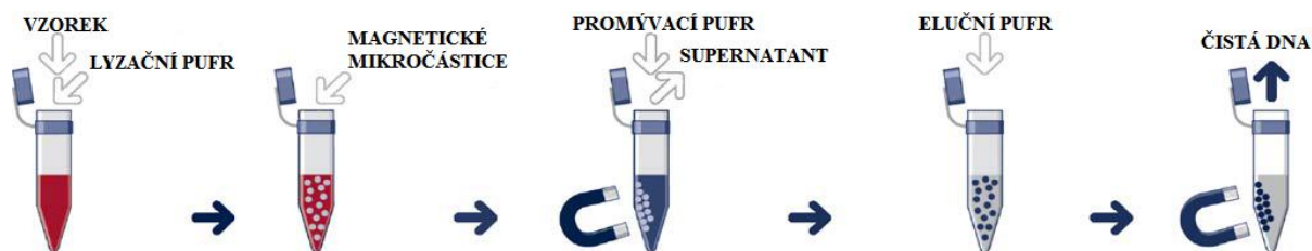
Obrázek 2 Schéma průběhu magnetické separace nukleových kyselin. Převzato z [5]
