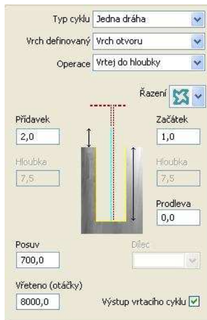
obr. 4.6 vrtání děr tzv. „na jednu dráhu“
