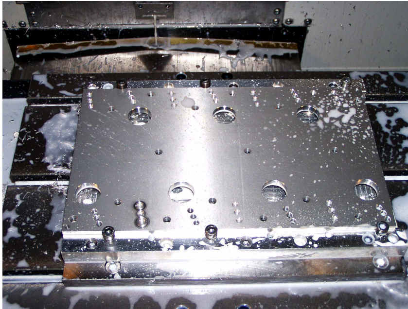
obr. 4.12 obrobený díl na pracovním stole obráběcího centra Haas VF-2SS
