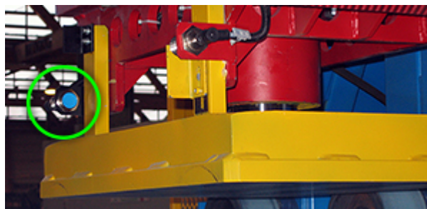
Obr. 2.7 Lisovací hlava a snímač IM30-10BPO-ZC1 [38]
