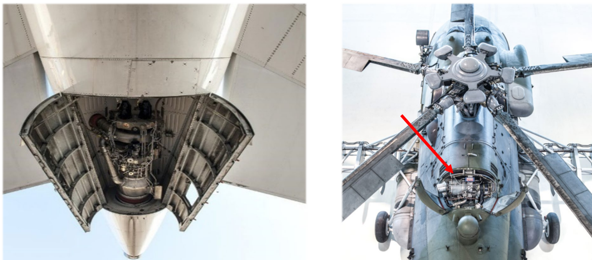
Obr. 2 Umístění APU na letounu a vrtulníku Mi-17 [8; 9].
