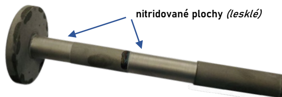
Obr. 21 Nitridovaná hřídel (předmět DP).
