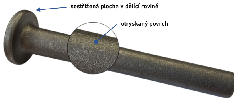
Obr. 23 Fyzický výkovek pro součást hřídele (předmět DP).
