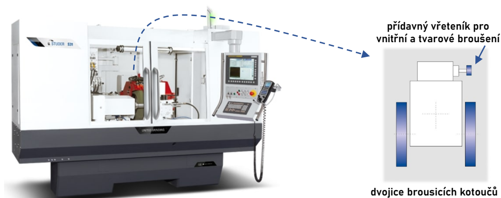
Obr. 26 Studer S31 a přítomná konfigurace revolverové nástrojové hlavy [60; 63].
