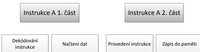
Obr. 3.2: Princip řetězení instrukcí.
