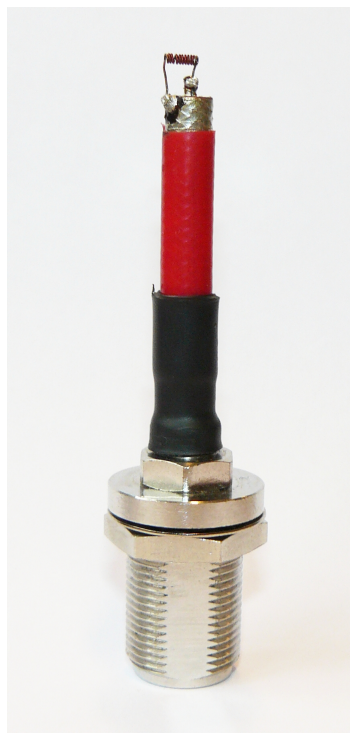
Obr. 3.7: Sonda pro měření magnetické složky elektromagnetického pole.
