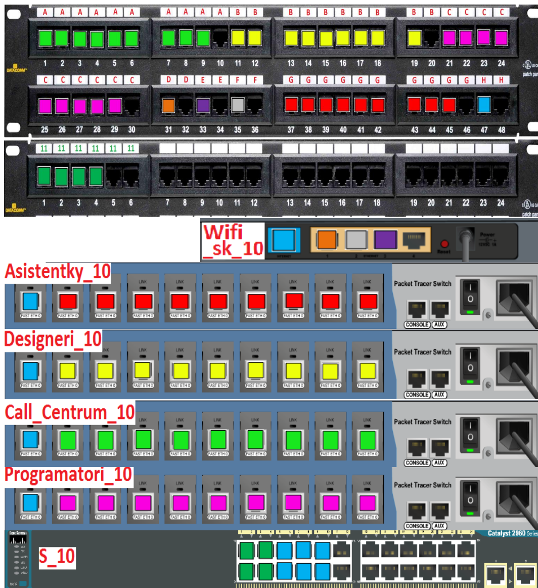
Obr. A.9: Barevné schéma zapojení síťových prvků, Rack 10.
