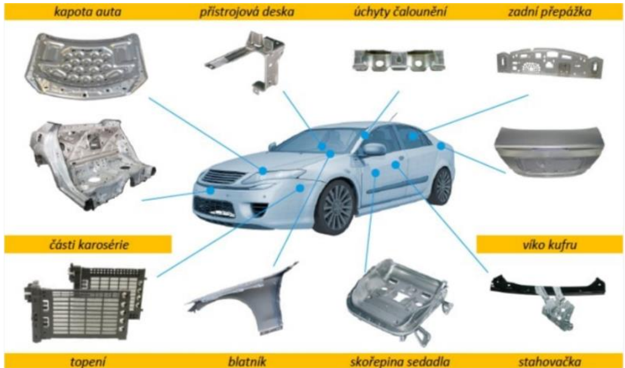
Obr. 5 Využití klinčování u automobilů [11]
