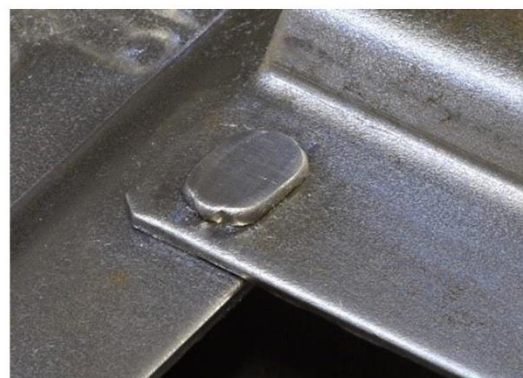
Obr. 48 Klinčové spoje firmy BTM v praxi [24]
