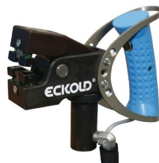
Obr. 37 Spojovací kleště MZD 25/3 PH [12]
