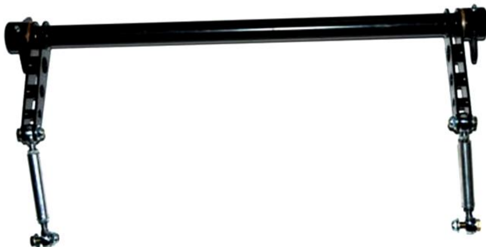
Obr. 20 Zkrutná tyč jako stabilizátor zadní nápravy [13]
