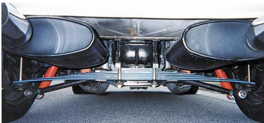
Obr. 6 Zadní náprava s příčně uloženou listovou pružinou [35]
