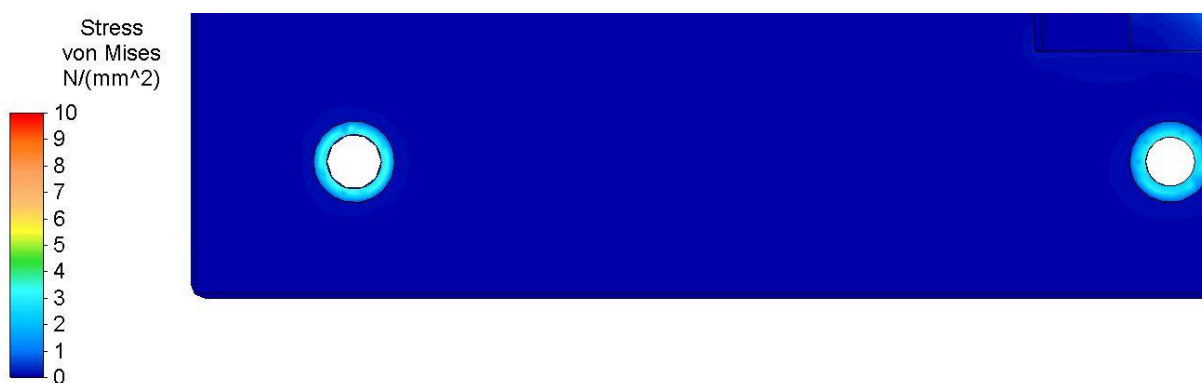
Obr. 66 Pevnostní analýza prostředního stojanu – Napětí von Mises – detail předepjatého šroubového spoje spodního
