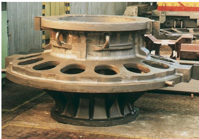
Obrázek 2 – Odlitek pláště plynové turbíny[4]
