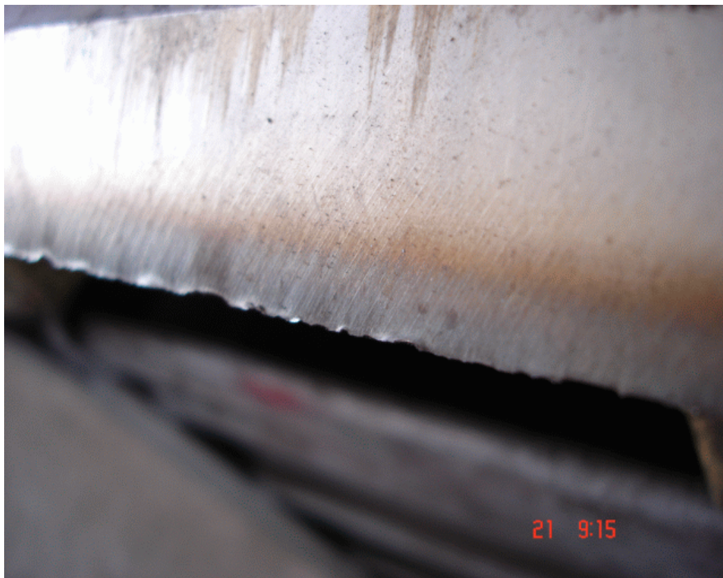
Obr.4.2 Ukázka poškozeného ostří nože
