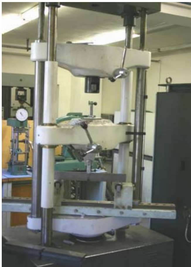
Obr. 4.8 Celkový pohled na zkušební stroj pro zkoušku ohybem
