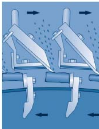
Obr.2.5 Ukázka principu použití roztřískovacích nožů (3)
