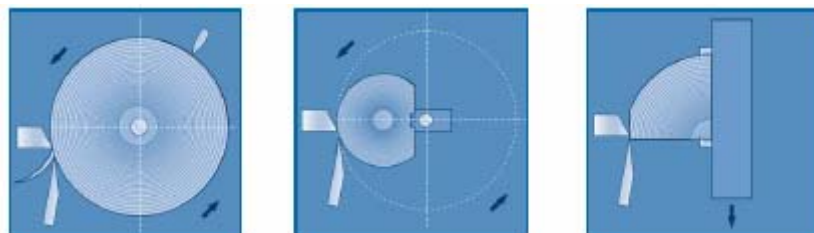
Obr.2.9 Ukázka principu použití nožů na dýhu (3)
