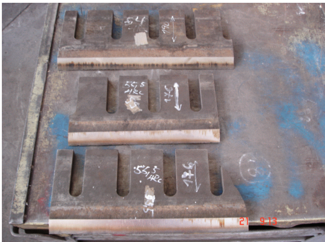
Obr.4.1 Ukázka zlomeného nože
