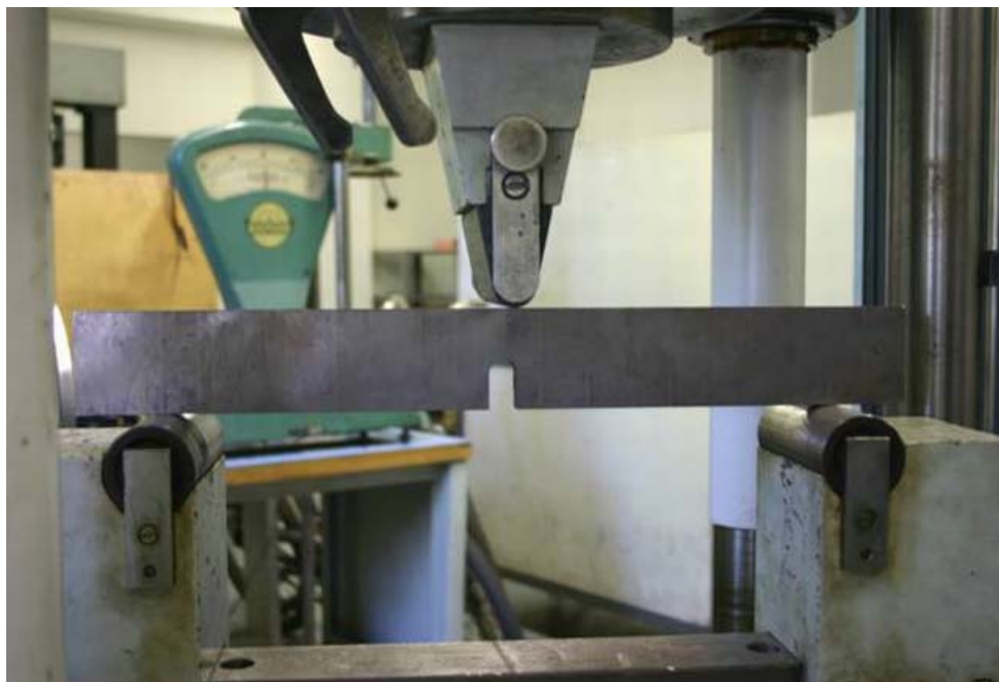
Obr. 4.9 Uspořádání zkoušky třibodovým ohybem
