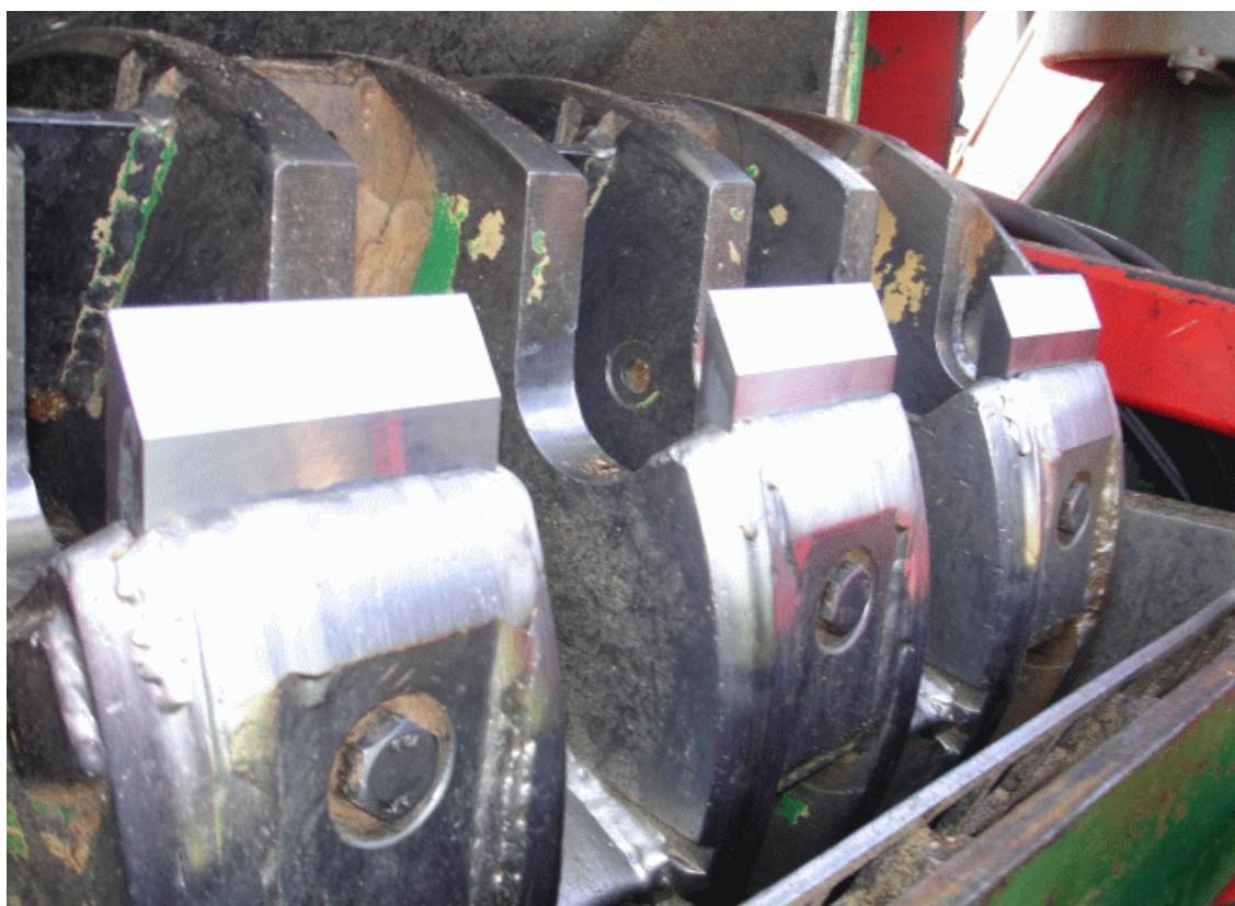
Obr.4.10 Nože Pilana upevněné ve stroji MUSMAX při praktické zkoušce
