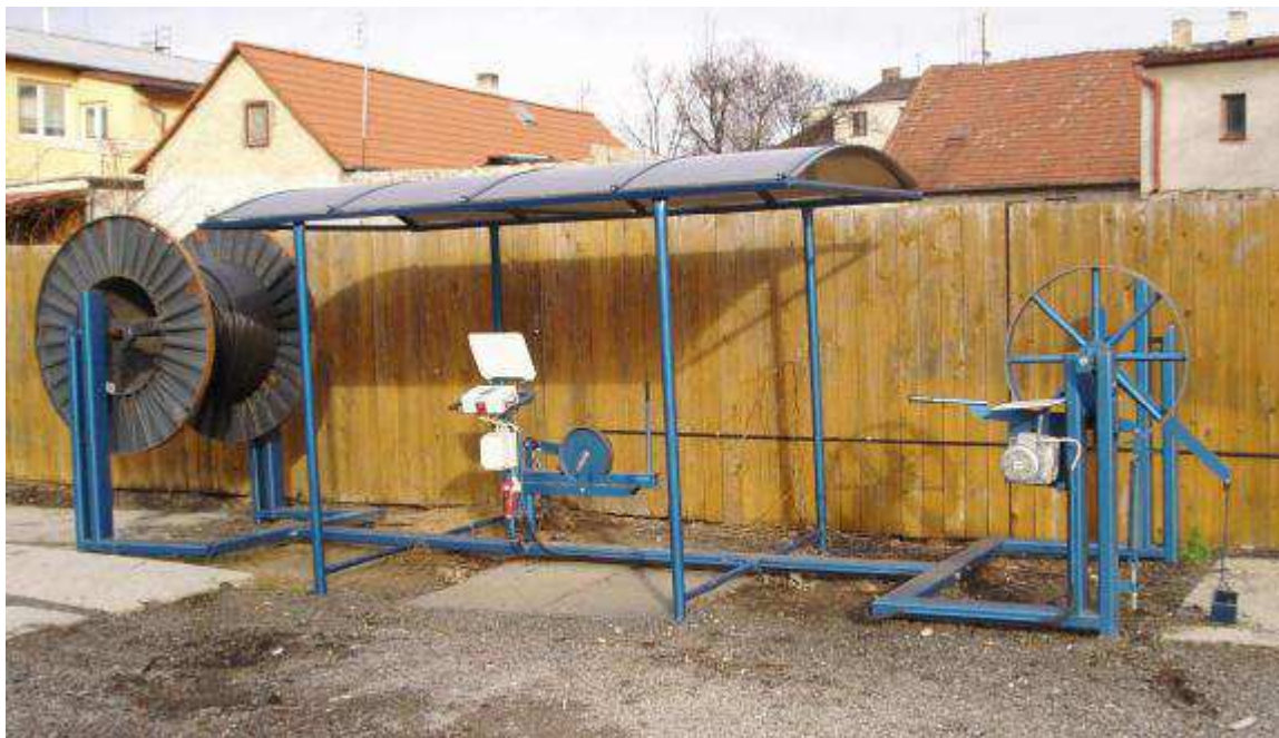
Obr. 11 Převíjecí zařízení BOD co. Vladimír Leheček [6]
