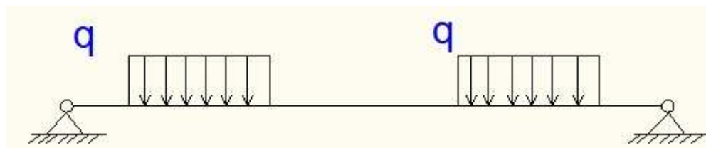
Obr. 23 Převedení na spojitě zatížení
