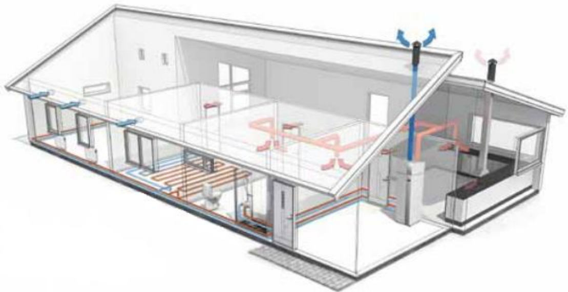
Obr. 4.5 Dům se systémem využívající ventilační tepelné čerpadlo [13]
