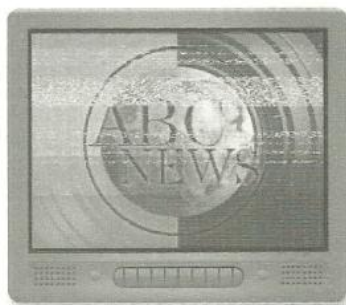
Obrázek 2.4 Rušení z impulzních zdrojů
