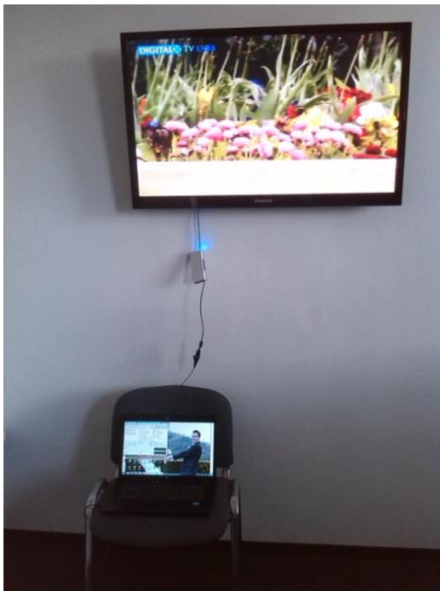
Obr. 57 Sestava pro testování HbbTV aplikace
