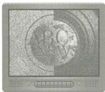
Obrázek 2.1 Sněžení v obraze způsobené nízkou úrovní signálu
