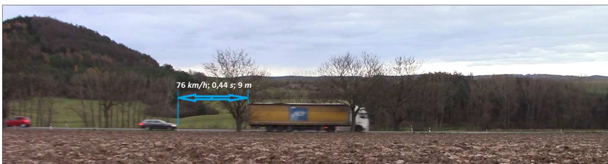
Obrázek 17: Rychlost vozidel 76 km/h, odstup druhého vozidla cca 0,44 s, resp. cca 9 m
