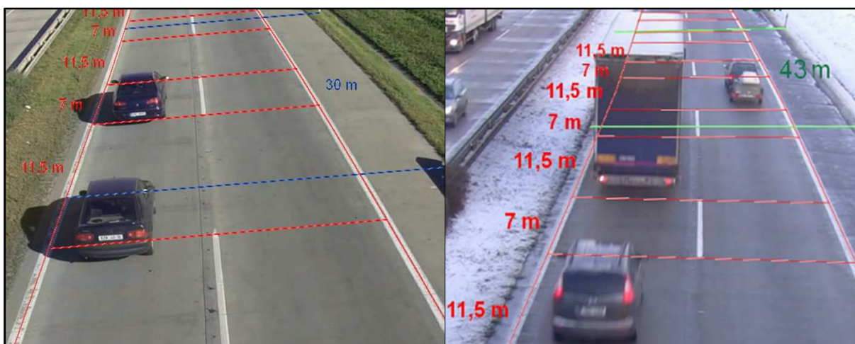
Obrázek 10: Rychlost vozidla 130 km/h, vzdálenost 7 m, resp. rychlost vozidla 98 km/h, vzdálenost 6 m
