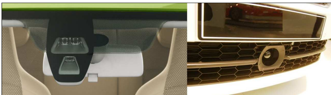
Obrázek 4: Laser Closing Velocity snímač, resp. elektromagnetický „radarový“ snímač [102]
