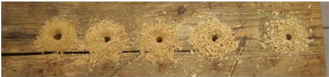
Obr. 16: Zbarvení a struktura pilin po vyvrtání mikrovývrtů [11]
