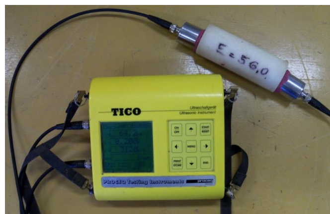
Obr. 14: Ultrazvukový přístroj TICO umožňuje použití více sond o různých frekvencích
