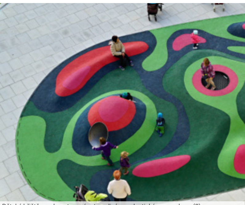
Dětské hřiště s polyuretanovým trvanlivým a elastickým povrchem (8)
