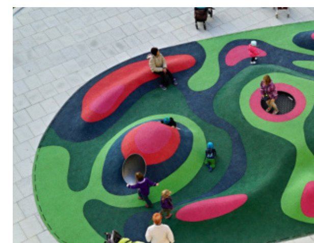
Dětské hřiště s polyuretanovým trvanlivým a elastickým povrchem (8)
