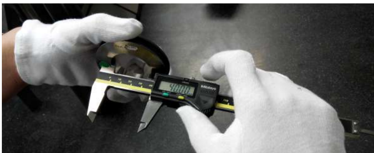
Obr. 3.9 Měření vnitřních rozměrů posuvného měřítka
