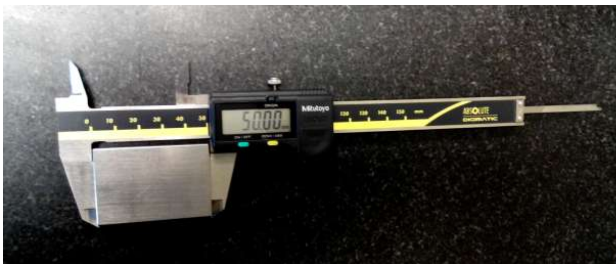
Obr. 3.8 Měření vnějších rozměrů posuvného měřítka
