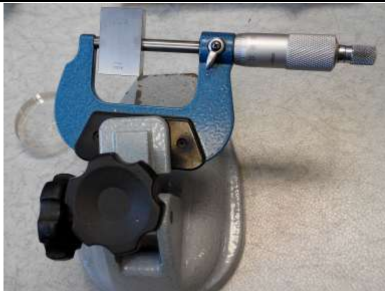
Obr. 3.11 Uchopení koncové měřky rovinnými doteky mikrometru
