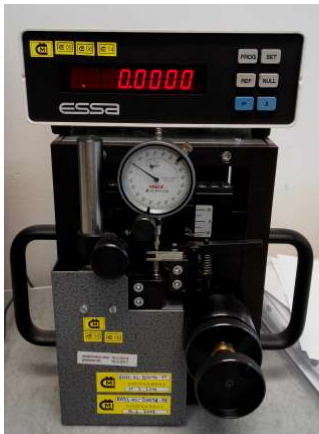
Obr. 3.5 Příklad přístroje MCU30 – PP s kalibrovaným úchylkoměrem
