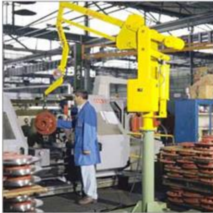
Obr.7 Manipulátor ukotvený pevně k podlaze [4]
