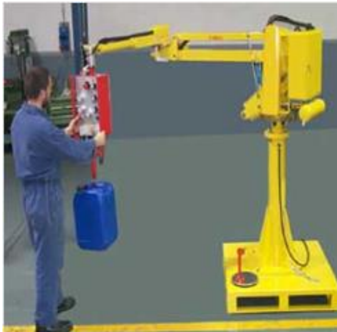
Obr.5 Mobilní manipulátor, konstruován na manipulaci pomocí manipulačního vozíku [2]
