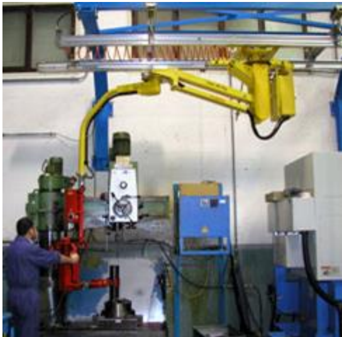
Obr.6 Manipulátor ukotvený pohyblivě na kolejnicích [3]
