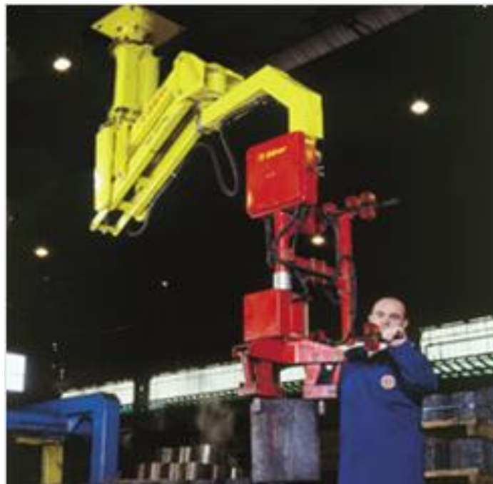
Obr.8 Manipulátor ukotvený pevně ke konstrukci haly [5]
