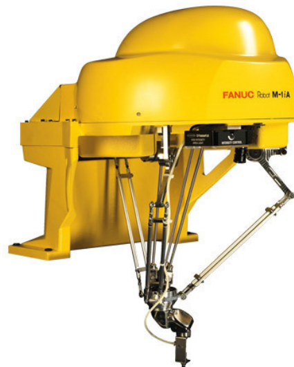
Obr. 2.7 – Příklad robota s paralelní kinematikou od firmy Fanuc [6]
