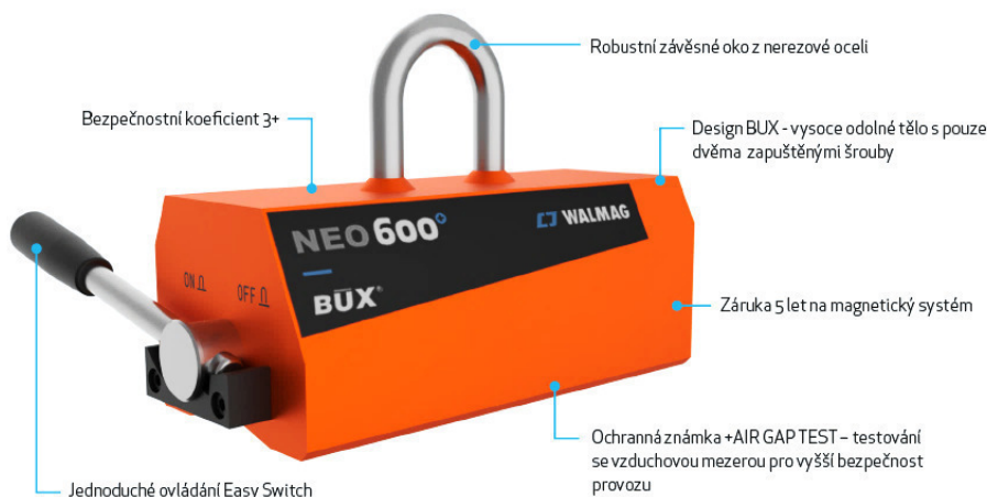
Obr. 2.9 – Úchopný permanentní magnet Walmag[7]
