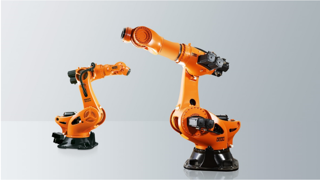
Obr. 2.1– Příklad robota se sériovou kinematikou [3]
