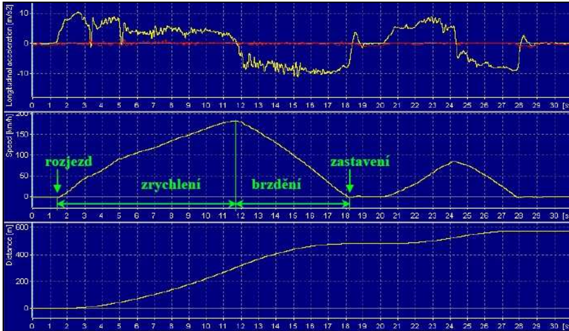
Graf. 1: Průběh měření na motocyklu Yamaha YZF R6 (vodorovná osa – čas [s], svislá osa shora – zrychlení [ \text{m/s}^2 ], rychlost [ \text{m/s} ], dráha [m])
