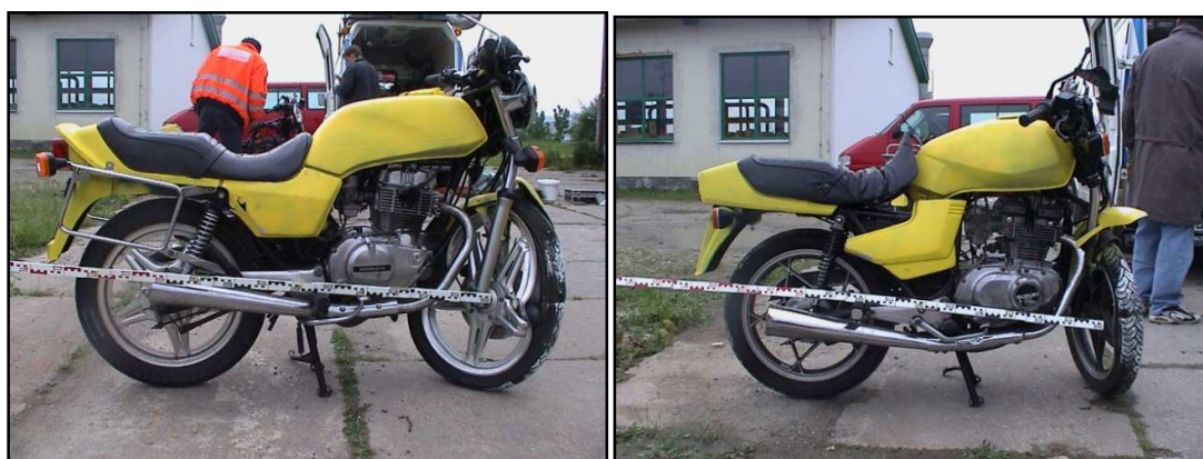
Obr. 59: EES = 65 km/h, zkrácení rozvoru 38 cm (vlevo)
