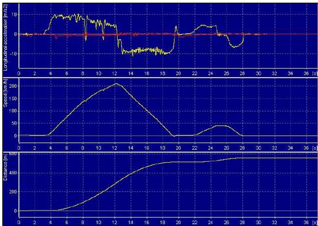
Graf. 4: Průběh měření na motocyklu Suzuki GSX-R1000 (vodorovná osa – čas [s], svislá osa shora – zrychlení [ \text{m/s}^2 ], rychlost [ \text{m/s} ], dráha [m])
