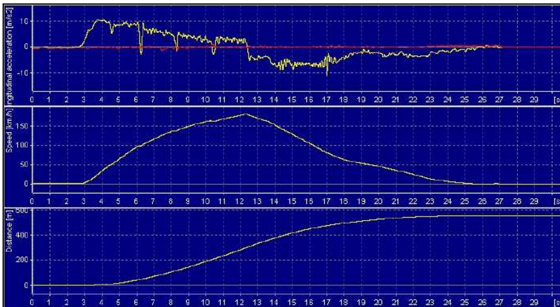
Graf. 3: Průběh měření na motocyklu Kawasaki Z750 (vodorovná osa – čas [s], svislá osa shora – zrychlení [ m/s^2 ], rychlost [m/s], dráha [m])
