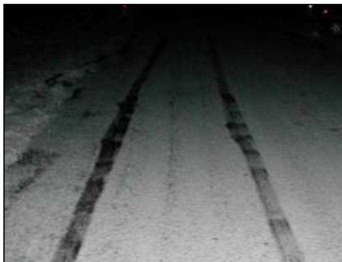
Obr. 69: ABS stopy vozidla na asfaltě
