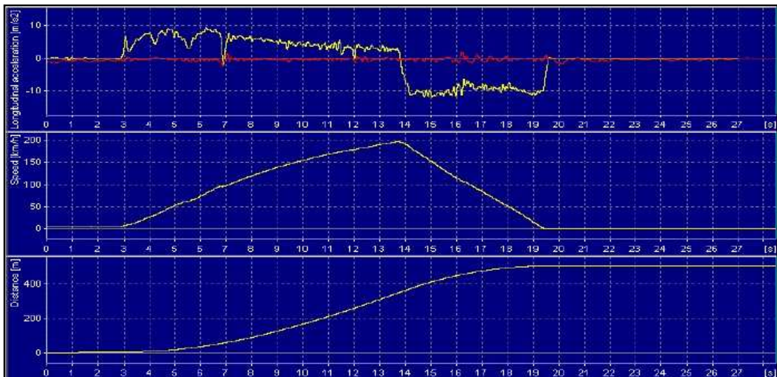
Graf. 6: Průběh měření na motocyklu Suzuki GSX-R600 (vodorovná osa – čas [s], svislá osa shora – zrychlení [ m/s^2 ], rychlost [m/s], dráha [m])
