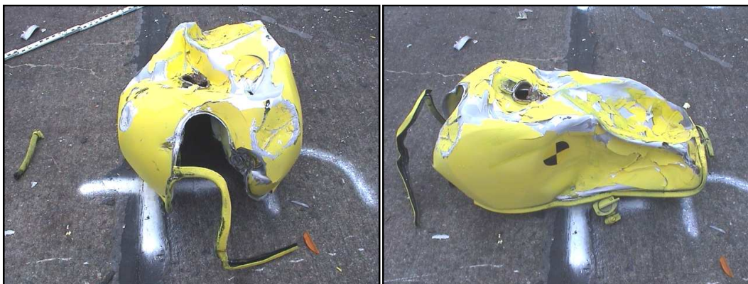
Obr. 41: Poškození nádrže – pohled zepředu (vlevo)
