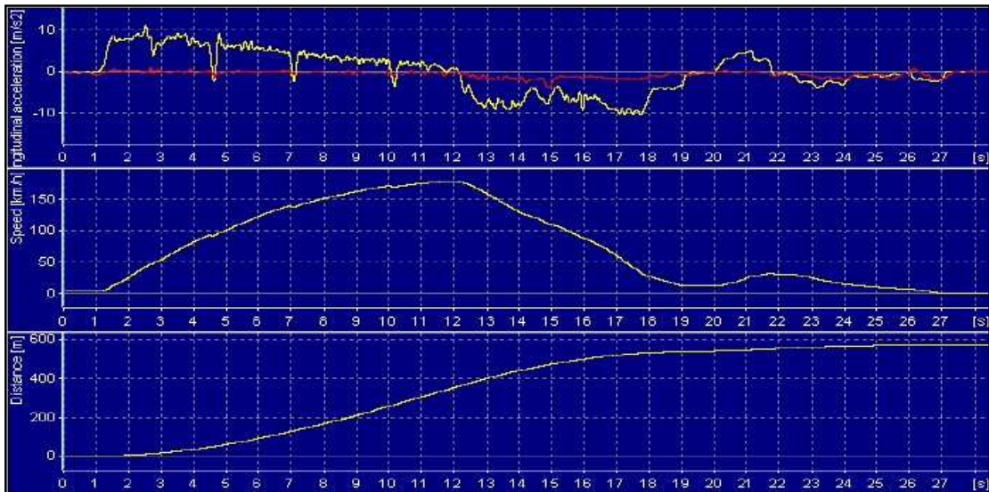
Graf. 5: Průběh měření na motocyklu Honda CB 600 Hornet (vodorovná osa – čas [s], svislá osa shora – zrychlení [ m/s^2 ], rychlost [m/s], dráha [m])
