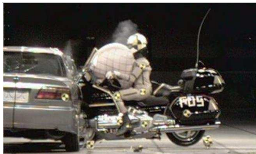
Obr. 3: Aktivovaný airbag na motocyklu Honda Goldwing při střetu s vozidlem
