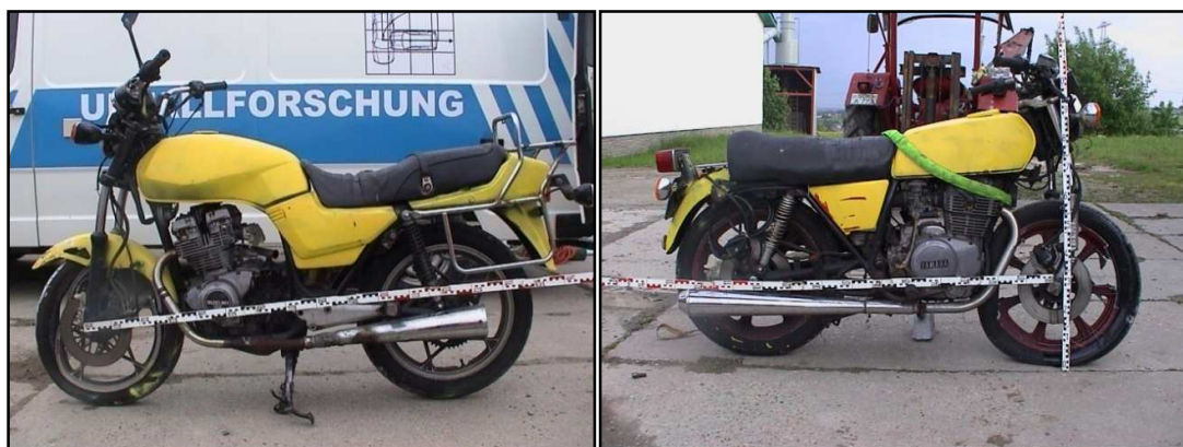
Obr. 57: EES = 38 km/h, zkrácení rozvoru 17 cm (vlevo)
