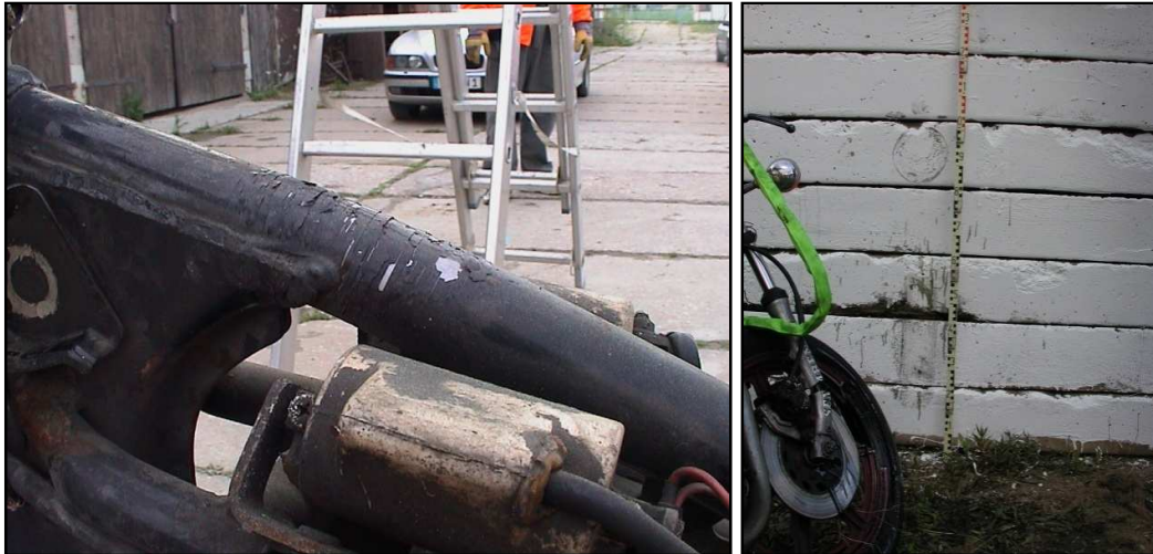
Obr. 52: Zdeformovaná horní trubice rámu a rozpoznatelné odloupení laku (vlevo)
