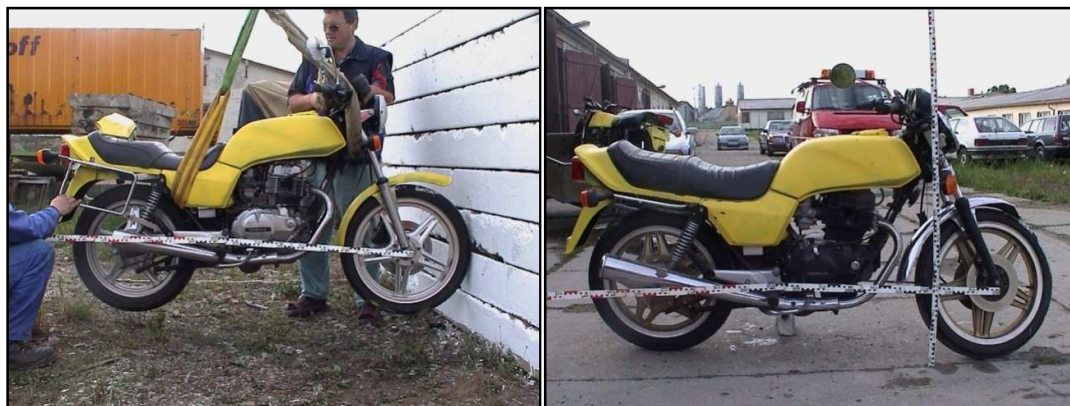
Obr. 55: EES = 17 km/h, zkrácení rozvoru 7 cm (vlevo)
