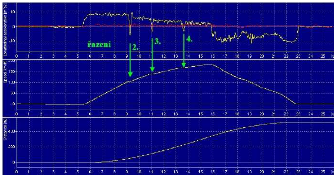
Graf. 2: Průběh měření na motocyklu Kawasaki Z1000 (vodorovná osa – čas [s], svislá osa shora – zrychlení [ m/s^2 ], rychlost [m/s], dráha [m])
