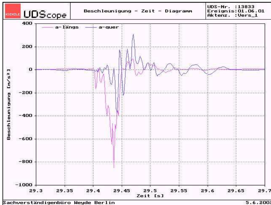
Obr. 54: Průběh podélného zrychlení v okamžiku nárazu motocyklu do betonových panelů
