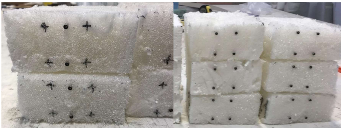
Obr. 9.3 - Zkušební vzorky – přechodová a pozdější varianta značek
