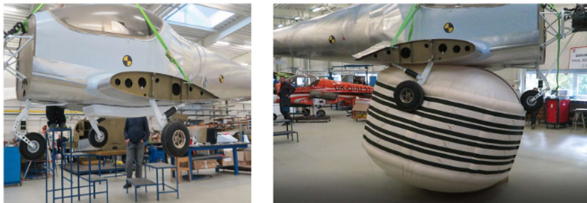
Obr. 4.8 - Systém airbagu SOFTLAND na letounu Skyleader [23]
