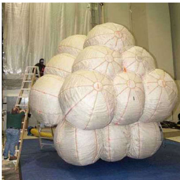
Obr. 4.13 - Airbasy přistávacího modulu Mars Exploration Rover [20]
