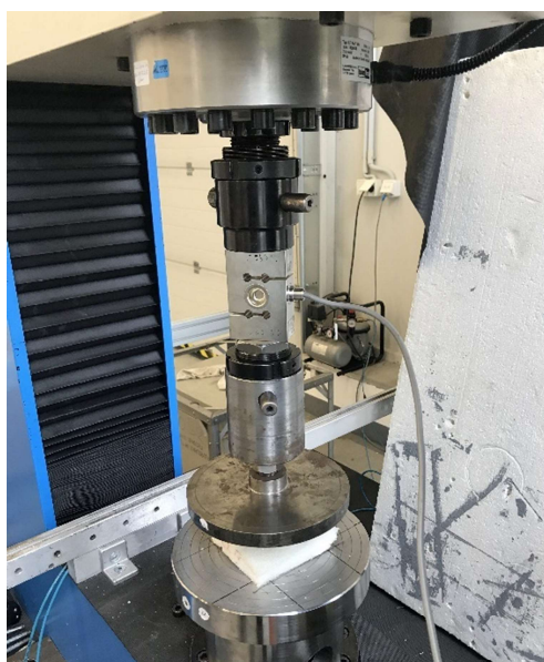
Obr. 9.4 - Vzorek ve zkušebním stroji, zapojení siloměru
