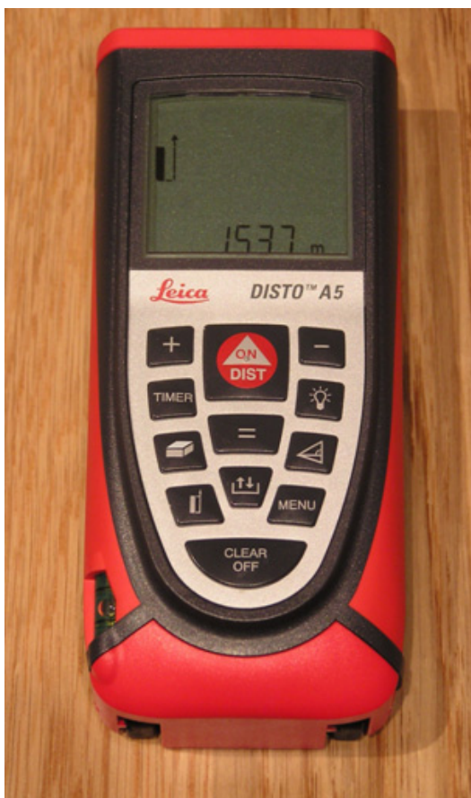
Obrázek 9.2 Laserový měřič vzdálenosti DISTO A5
