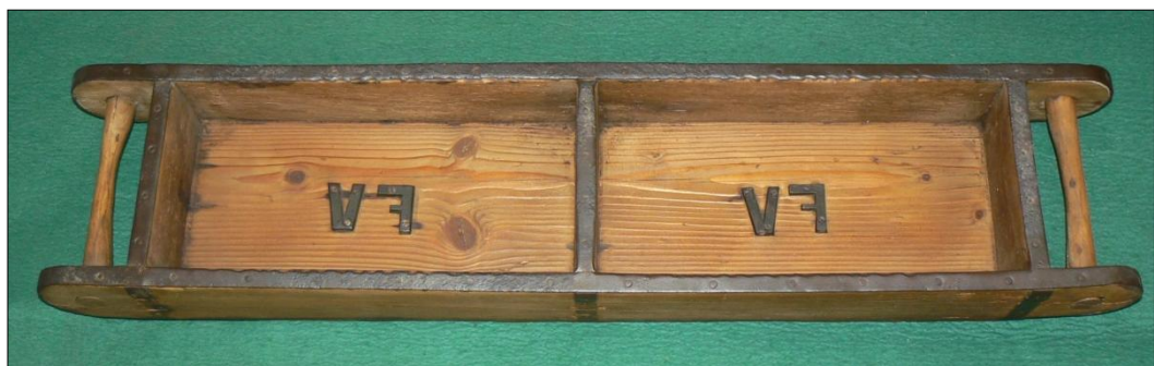
Dřevěné formy pro ruční výrobu cihel
