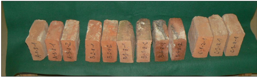
Obr.48 Sada zkoušených půlek cihel
