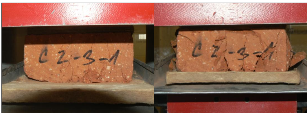
Obr.49 Ukázka cihel před a po porušení
