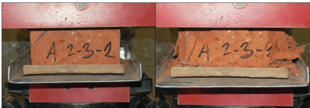
Obr.50 Ukázka cihel před a po porušení
