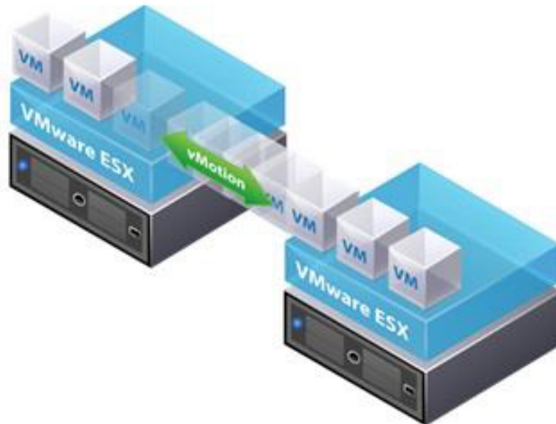
Obr. č. 2: Migrace virtuálních strojů pomocí vMotion
