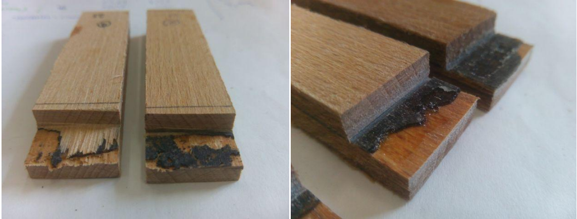
Obr. 28: Vzorek s 25 % plniva po expozici A1 (Porušení 40 %)
