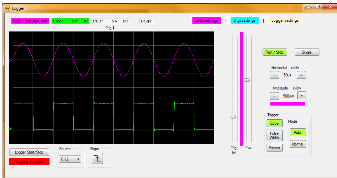
Obr. 7.35: Test vstupnej amplitúdy: sínus 1.14 Vpp (10 kHz)
