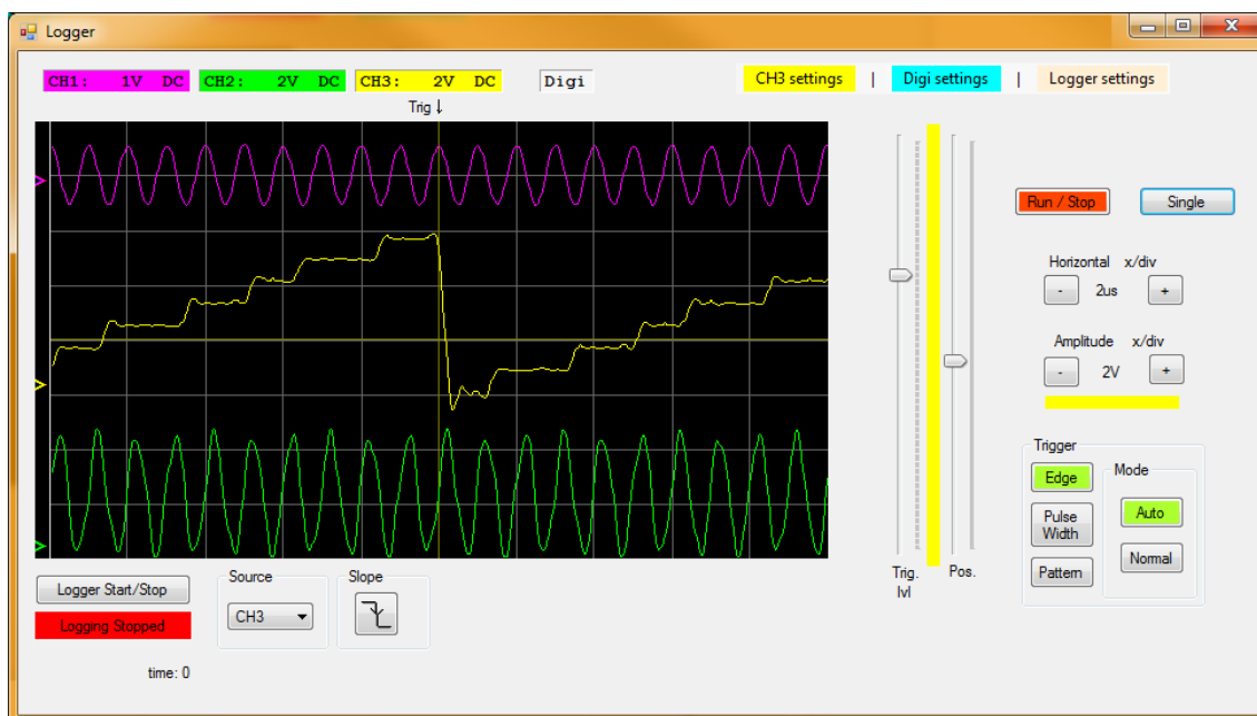
Obr. 7.40: Test časovej základne: sínus 1 MHz (1 Vpp)
