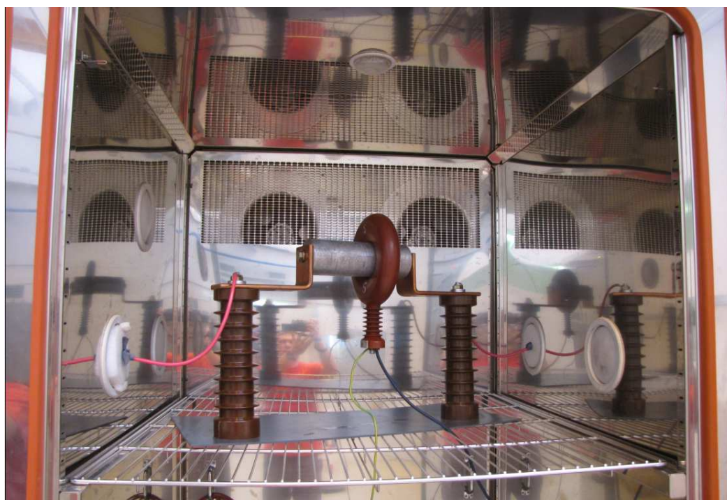
Obrázek 49 Měření senzor umístěný v klimatické komoře
