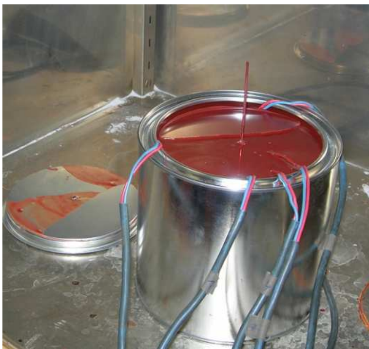
Obrázek 53 Plechovka po vytvrzení epoxidu
