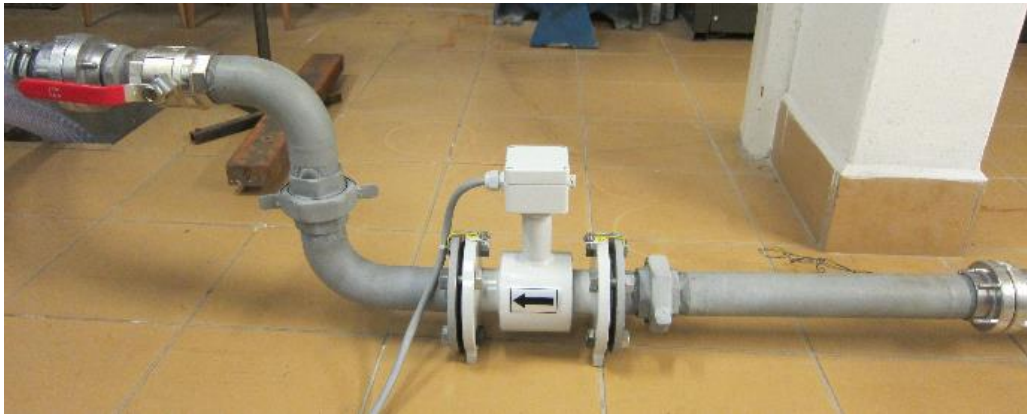
Obrázek 58 Přenosná měřicí sestava subjektu MI FLOW s.r.o.; zdroj: [10]
