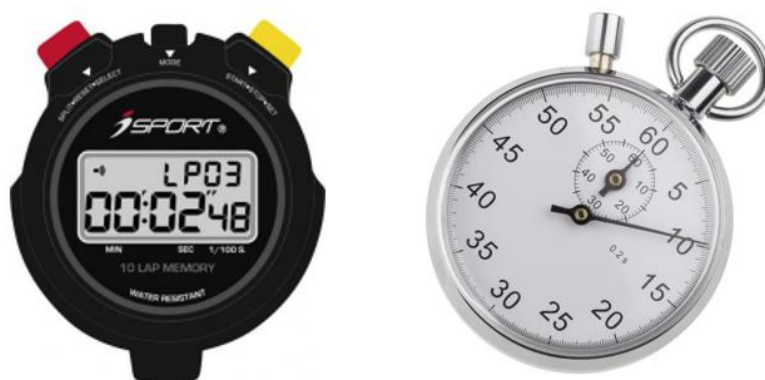
Obrázek 52 Digitální (vlevo) a mechanické (vpravo) stopky; zdroj: https://www.meteostanice.cz ; https://media.rs-online.com
