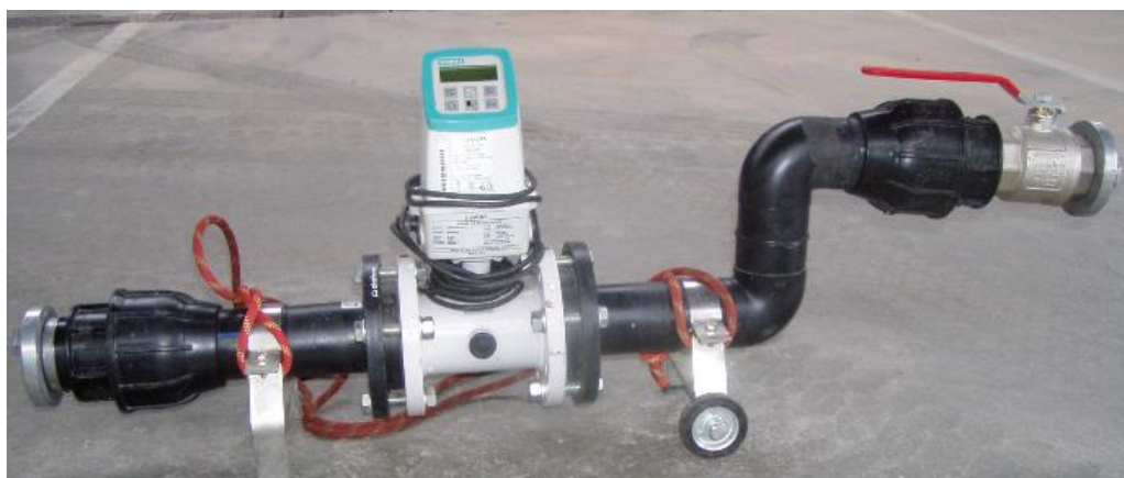
Obrázek 59 Přenosná měřicí sestava subjektu Pražské vodovody a kanalizace a.s.; zdroj: [10]
