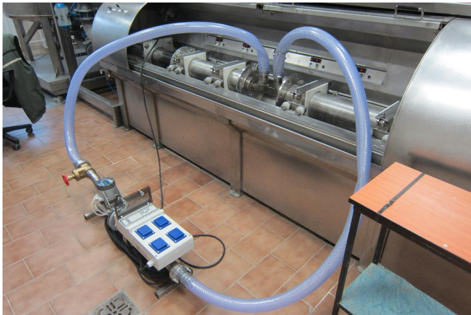
Obrázek 53 Kalibrace měřicí sestavy s indukčním průtokoměrem v AKL ČMI OI Brno; zdroj: (2)
