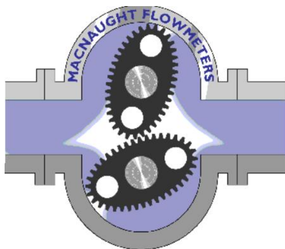
Obrázek 10 Oválový průtokoměr schéma; zdroj: http://www.lpc-uk.com
