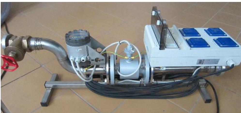
Obrázek 57 Přenosná měřicí sestava subjektu FAST VUT v Brně; zdroj: [10]
