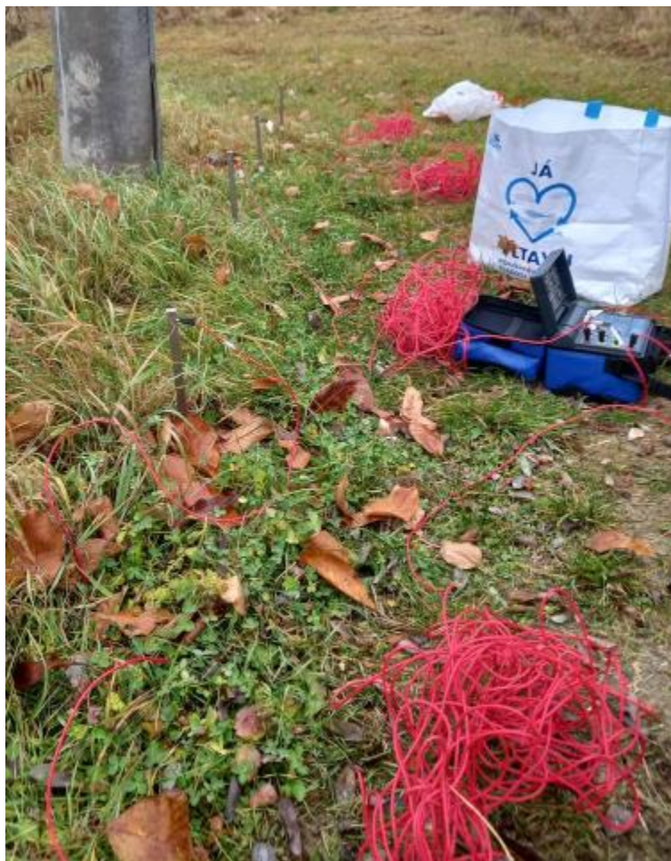
Obrázek 5.9 Ukázka měření rezistivity půdy u sloupů VN pro a = 1 a 3 m
