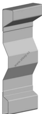
Obr. 26 Bočnicový profil Fuhrmann B450/2 [23]
