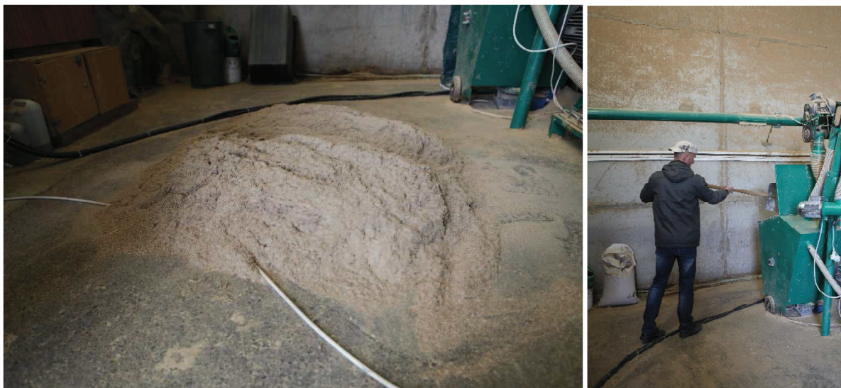
Obrázek 60. Rozdrcený rákos (rácový šrot), dávkování do peletovací linky
