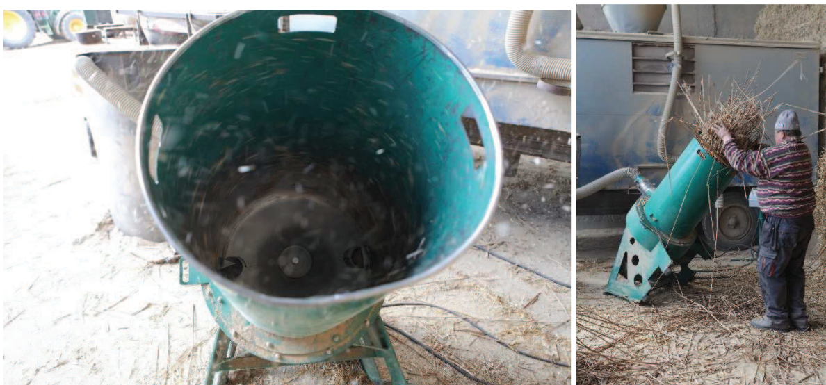
Obrázek 59. Drcení rákosu pomocí řezacího šrotovníku
