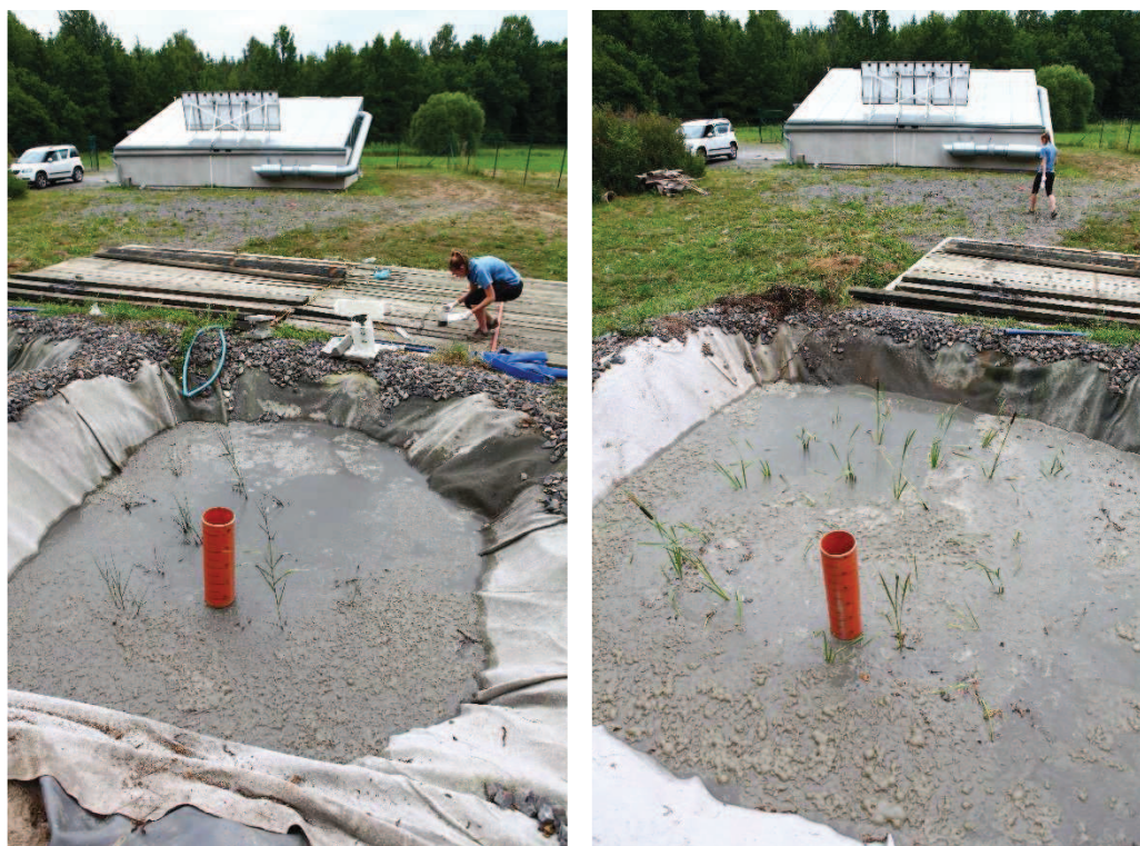
Obrázek 48. Reed-bed v Kotenčích těsně po aplikaci kalu dne 2. 7. 2014 - zleva: rákos obecný, orobinec úzkolistý
