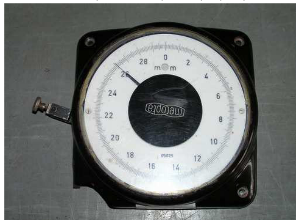
Obrázek 2 - mostní krabicový průhyboměr Metra - Fryč
