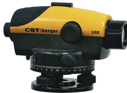
Obrázek 11 - nivelační přístroj Berger PAL26D s přiblížením 26x a přesností 0,1 mm/m
