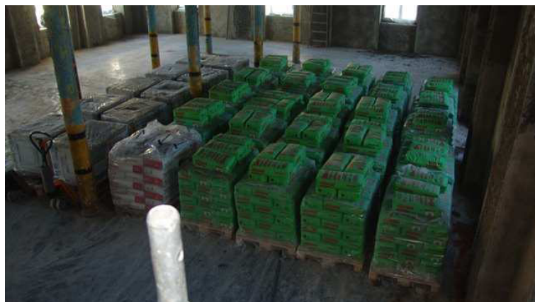
Obrázek 14 - zatěžování volným materiálem
