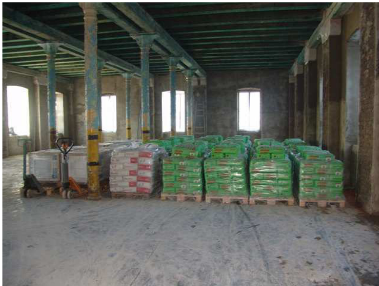
Obrázek 36 - Zkušební zatížení, sestava A+B
