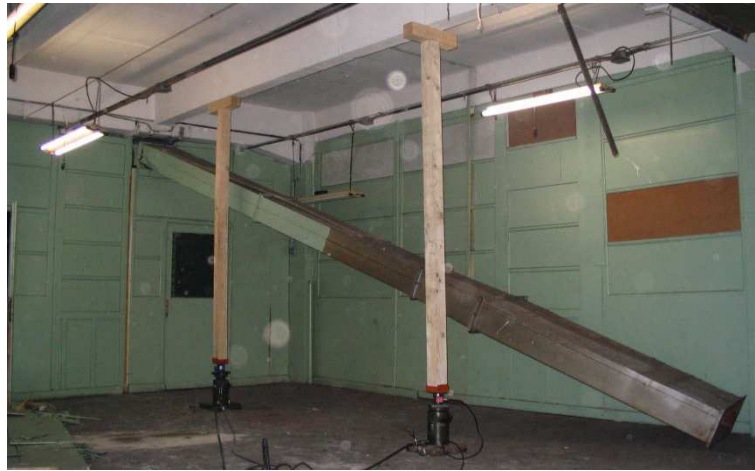
Obrázek 13 - zatěžování hydraulickými lisami
