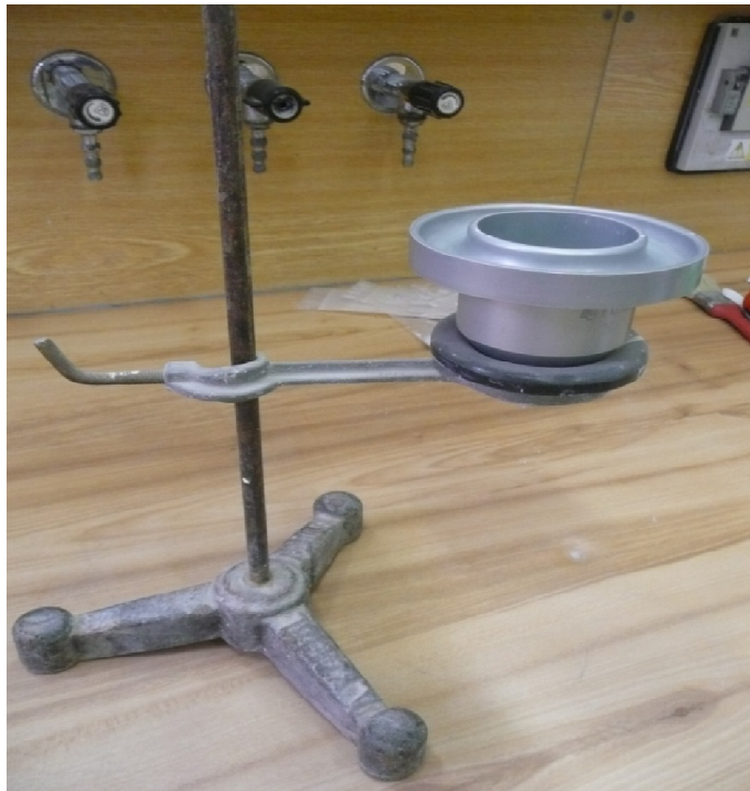
Obr. 11: Fordův kelímek připravený ve stojanu
