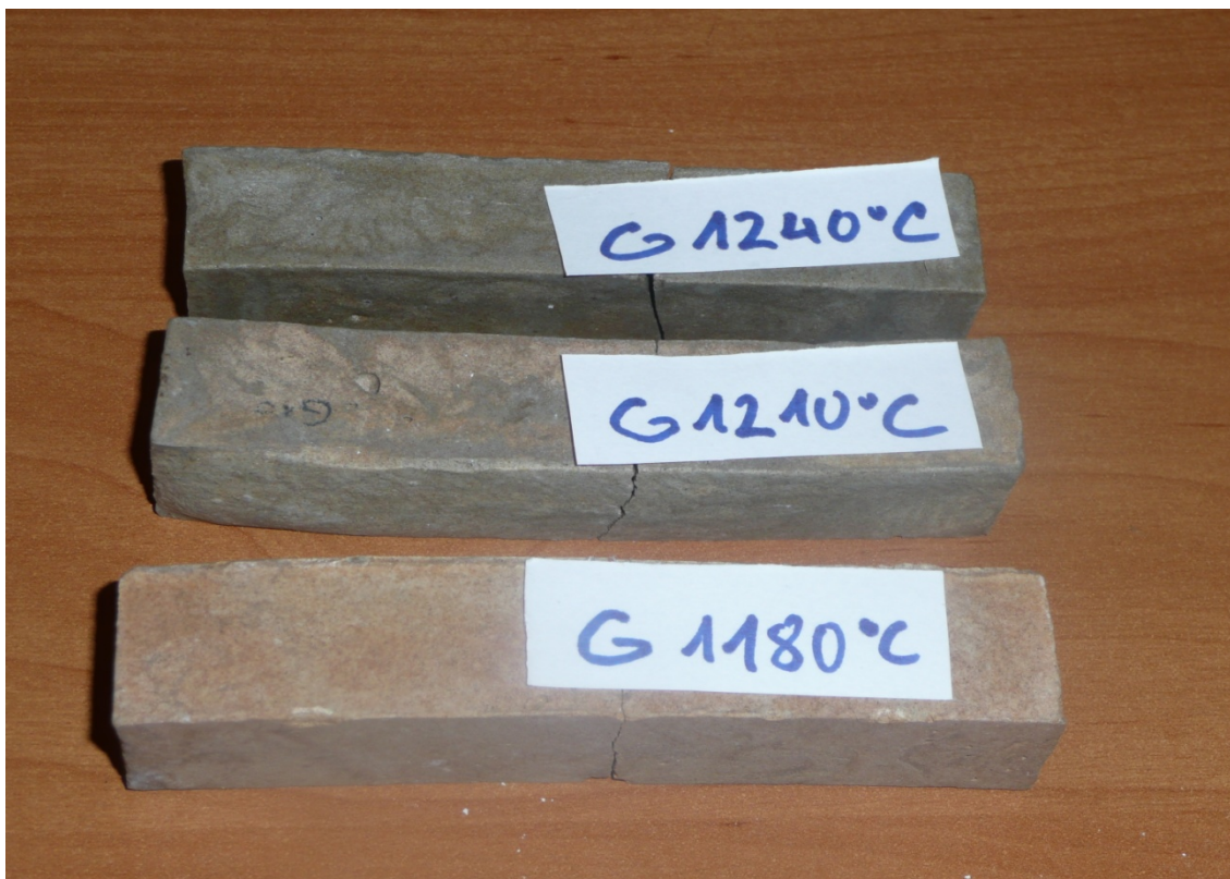
Obr. 16 Změna barvy vzorků receptury G v závislosti na teplotě výpalu
