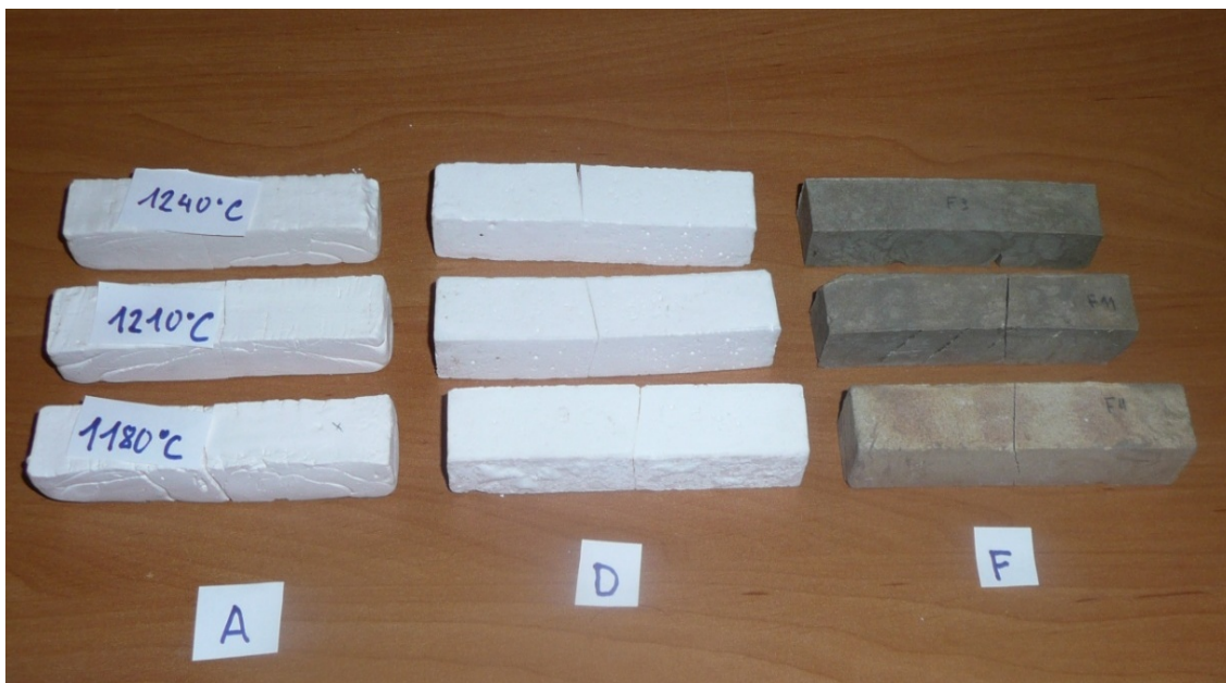
Obr. 17 Porovnání barvy vzorků po výpalu v závislosti na složení a teplotě výpalu
