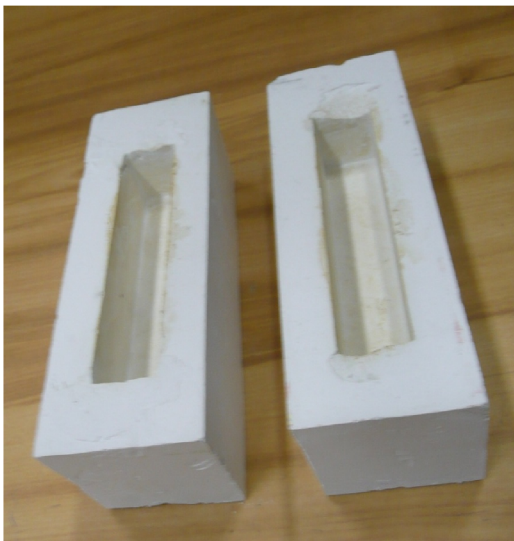
Obr. 12: Sádrové formy pro odlévání
