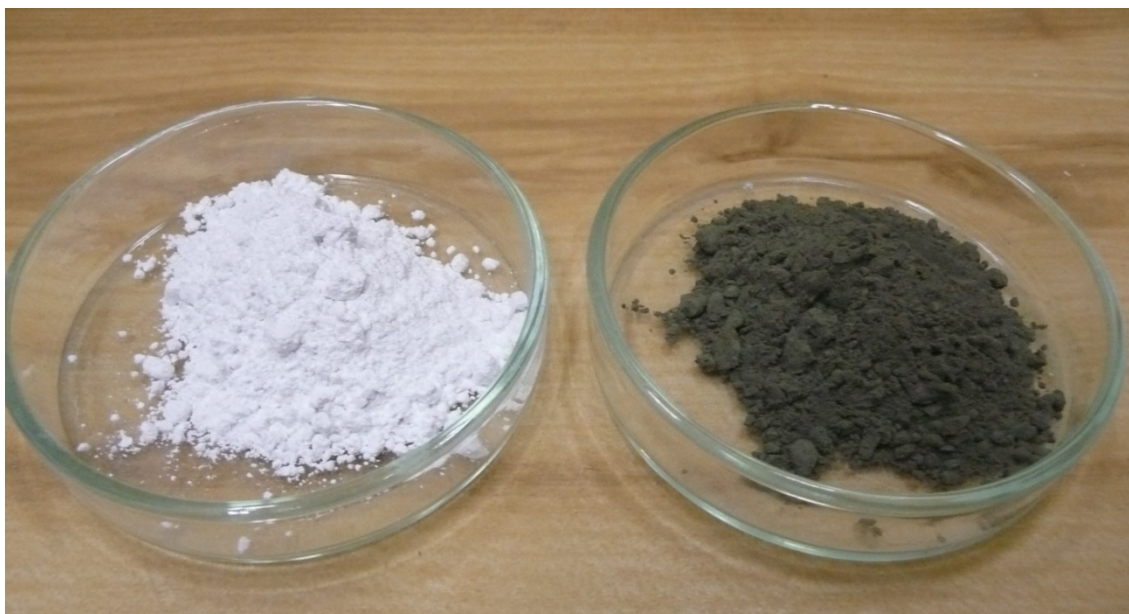
Obr. 10: Rozdíl zbarvení cementů, vlevo Almatis C14M, vpravo Istra 40
