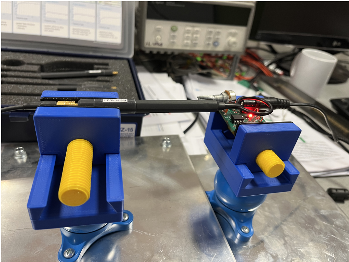
Obr. 6.5: Držák pro stabilní testování pomocí sond blízkého pole
