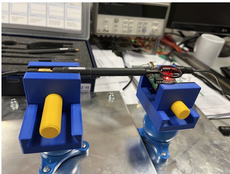
Obr. A.4: Ukázka správného uspořádání stanoviště pro měření sondami blízkého pole
