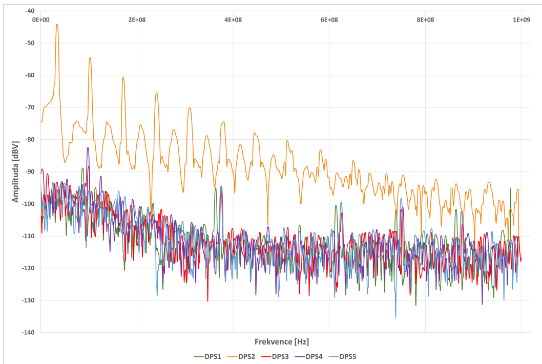
Obr. 6.6: Porovnání spekter EMI z DPS1-DPS5 měřených sondou H 400-1 (FFT) při frekvenci spínání 100 Hz
