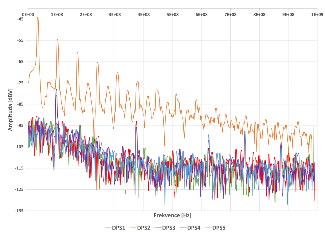
Obr. 6.7: Porovnání spekter EMI z DPS1-DPS5 měřených sondou H 400-1 (FFT) při frekvenci spínání 500 Hz
