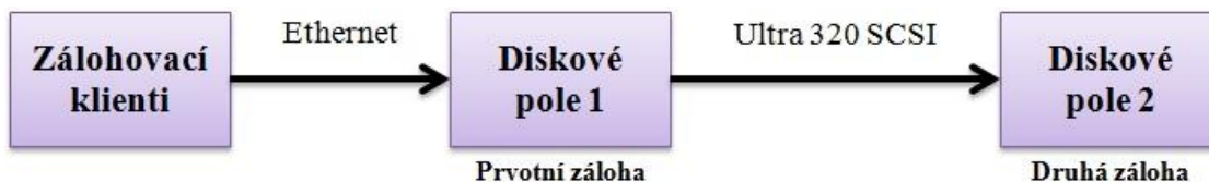
Obr. 3: Schéma zálohování D2D (Zdroj: upraveno dle 5)
