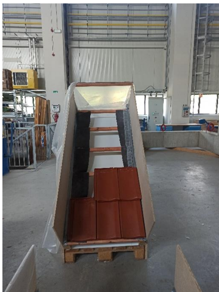
Obr. 26: Vlevo ukázka pokládky střešních tašek; vpravo model připravený na nasypání umělého sněhu do koryta
