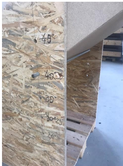
Obr. 25: Příprava modelu střechy: vlevo připravený model střechy v horizontální poloze; vpravo detail pro zvednutí modelu do požadovaného sklonu
