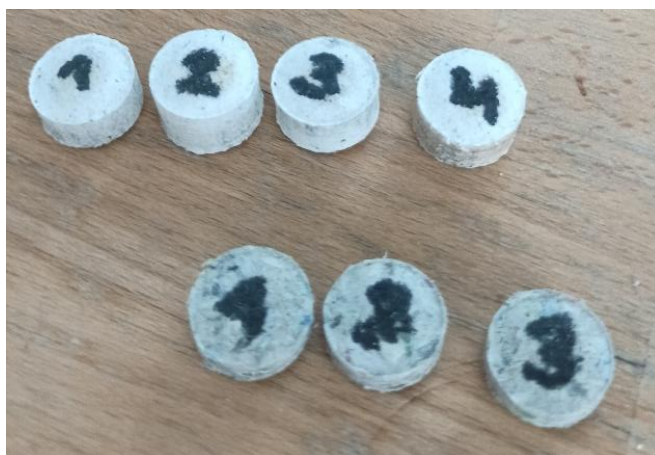
Obr. 17: Slisované vzorky, připravené pro určování zdánlivé objemové hmotnosti
