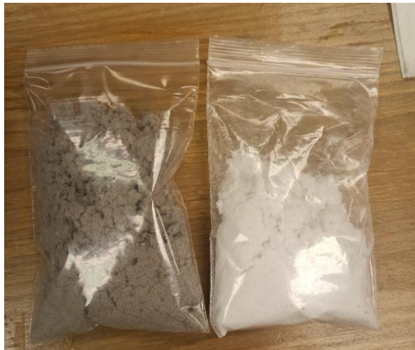
Obr. 15: Ukázka zkoušených materiálů – vlevo celulóza 2 (používaná pro foukané izolace; vpravo celulóza 1 (používaná jako ve filmovém průmyslu)
