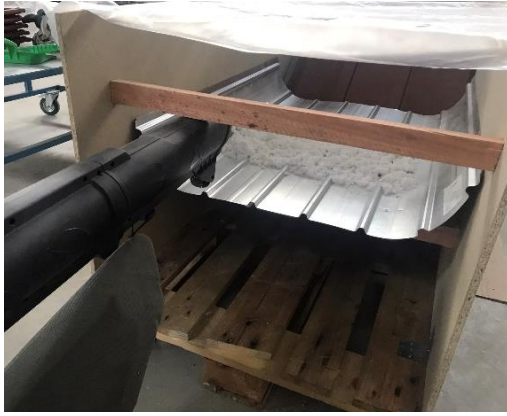
Obr. 28: Vlevo poloha fukaru před zkoušením; vpravo ukázka zafoukaného umělého sněhu pod taškami
