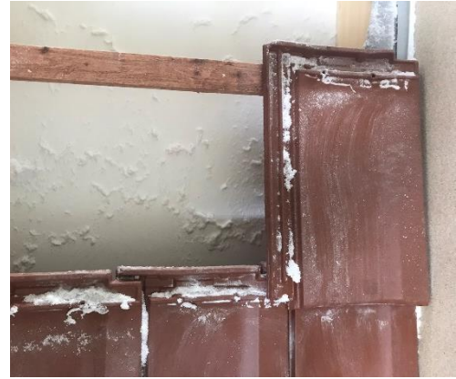
Obr. 28: Vlevo poloha fukaru před zkoušením; vpravo ukázka zafoukaného umělého sněhu pod taškami
