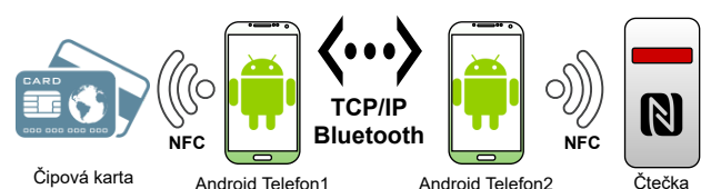
Obrázek 3: Princip útoku přeposláním zprávy.
