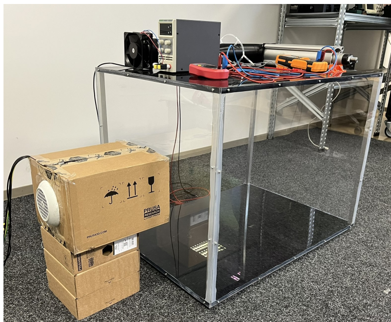
Obr. 5.1: Pracoviště pro měření tlakové charakteristiky radiálního ventilátoru.
