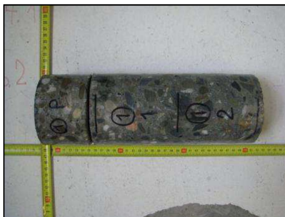
Obr. 1b Vzorek PN.1.01 s vyznačenou polohou zkušebních těles
