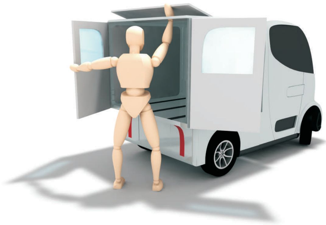
obr. 4.7 - částečně výklopná střecha
