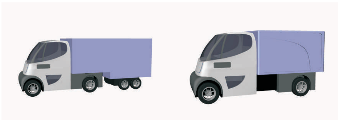
obr. 3.5 - varianta s návěsem a roztahovacím podvozkem
