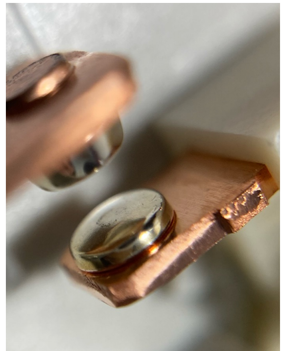
Obr. 7.8: Detail stykového místa spodního kontaktu stykače Sa2 ( \text{AgNi} )
