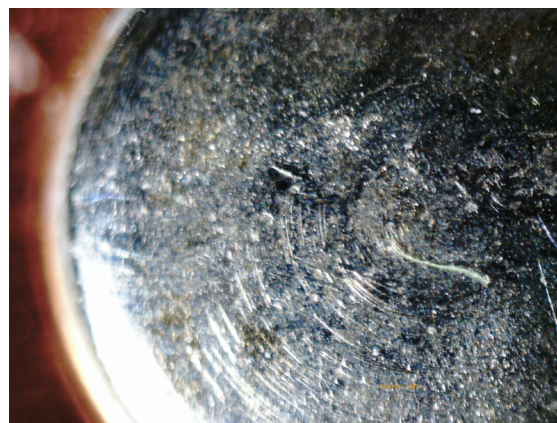
Obr. 7.10: Pohled mikroskopem na spodní kontakt stykače Sa2 ( \text{AgNi} )
