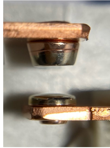
Obr. 7.6: Detail kontaktu instalačního stykače Sa2 ( \text{AgNi} )
