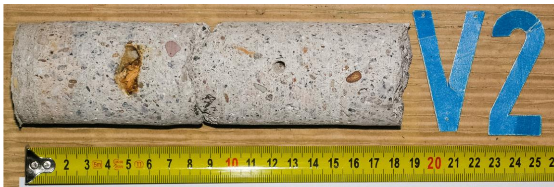
Obrázek 8.26 Jádrový vývrt V2 – Ø 50 mm, odebrán z pravého trámu
