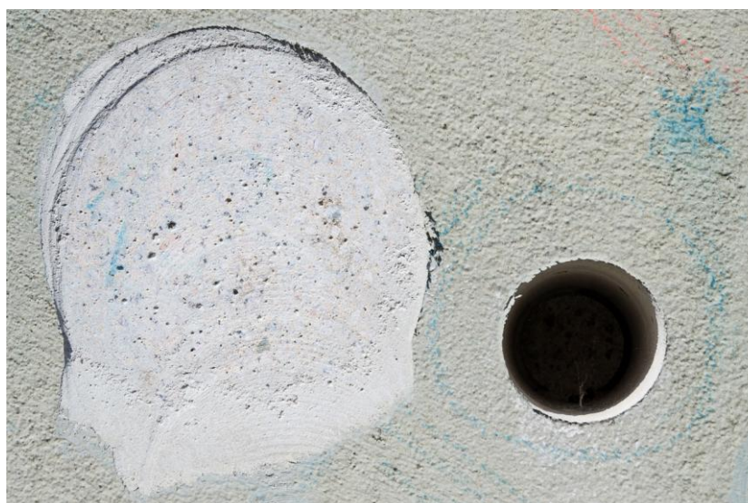
Obrázek 8.23 Sousedící místo pro NDT zkoušku (vlevo) a jádrový vývrt (vpravo)
