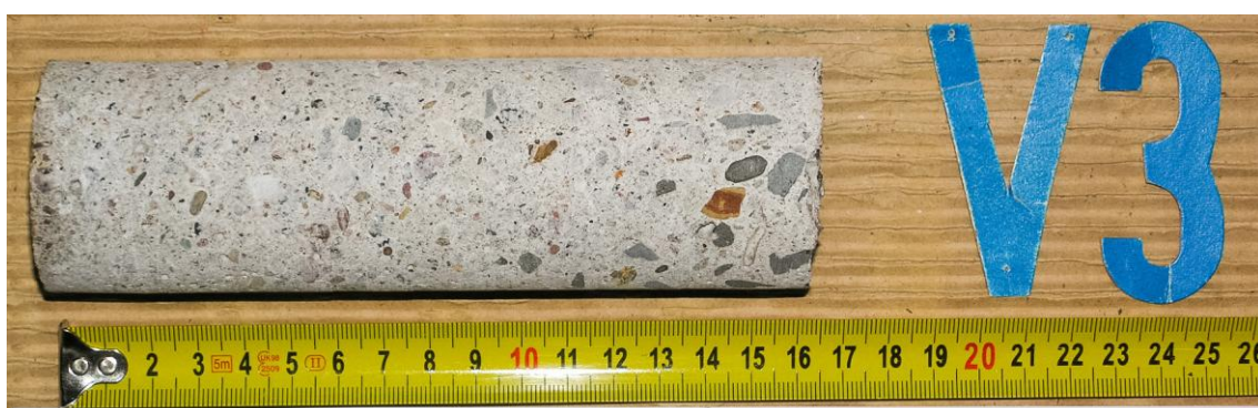
Obrázek 8.27 Jádrový vývrt V3 – Ø 50 mm, odebrán z příčnicku č. 6
