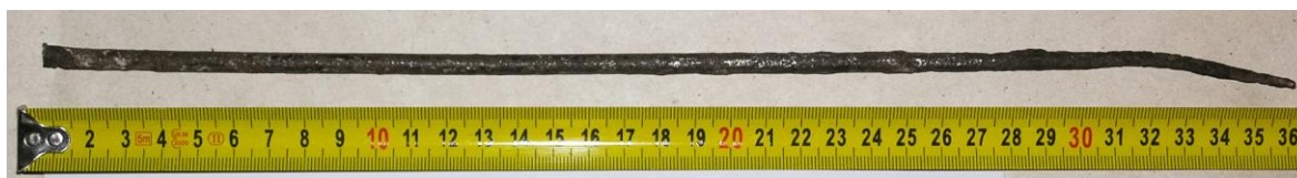
Obrázek 8.28 Sonda S11 – část třmínku ze závěsu č. 4 levého oblouku
