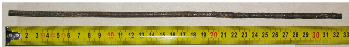
Obrázek 8.29 Sonda S12 – část třmínku ze závěsu č. 2 pravého oblouku
