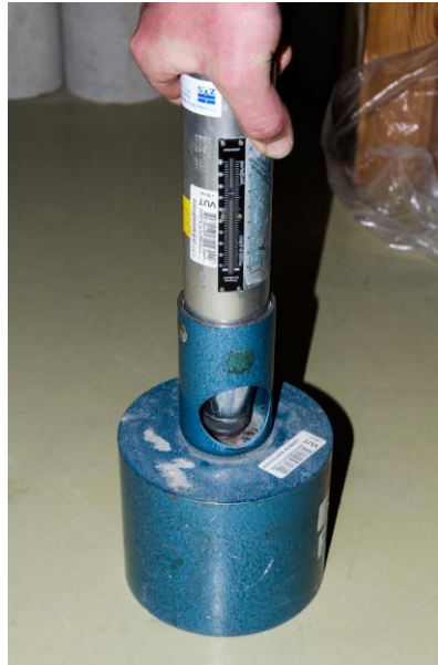
Obrázek 3.7 Kalibrace Schmidtova tvrdoměru typu N na zkušební kovadlině
