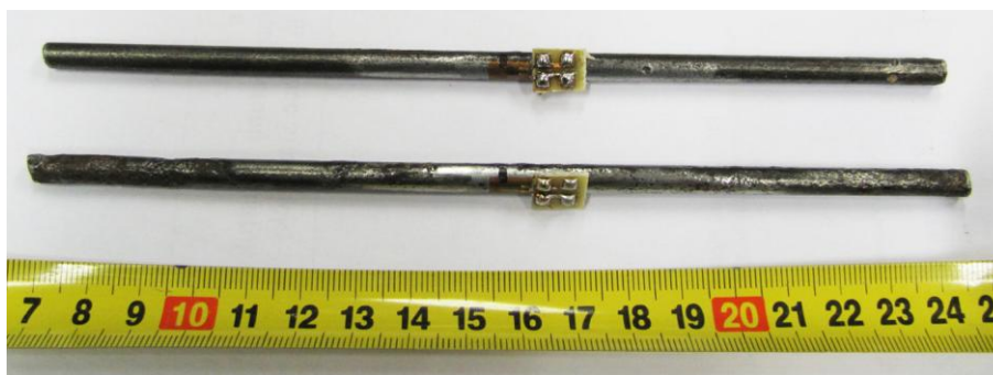
Obrázek 8.30 Zkušební tělesa před zkouškou v tahu s nalepenými tenzometry
