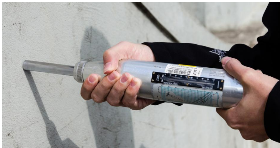
Obrázek 3.8 Měření Schmidtovým tvrdoměrem typu N
