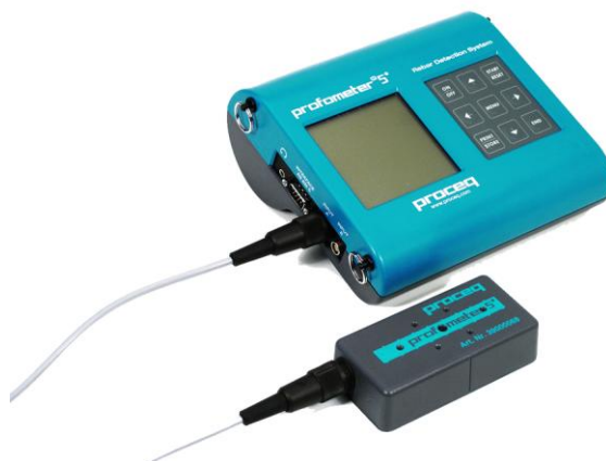
Obrázek 3.3 Přístroj Profometer 5+ pro indikaci výztuže v betonu [22]
