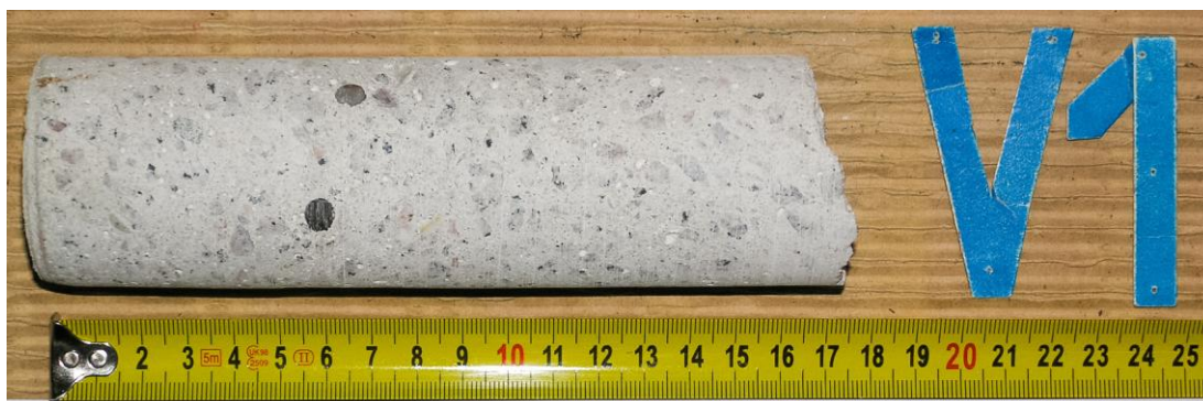
Obrázek 8.25 Jádrový vývrt V1 – Ø 50 mm, odebrán z pravého oblouku
