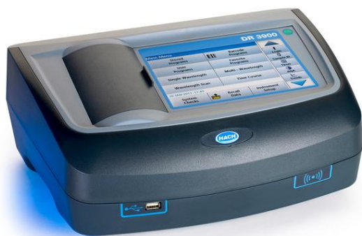
Obrázek č. 11: Laboratorní spektrofotometr Hach DR3900 pro analýzu vody [7]
