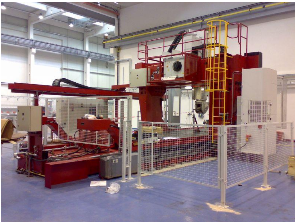
Obrázek 2 - ukázka obráběcího centra s posuvným portálem FRF [17]
